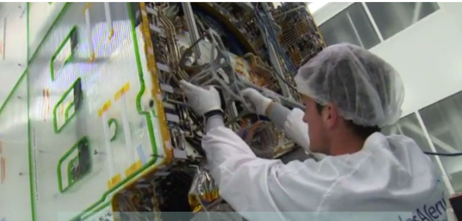
Fig.13 - Composant fabriqué par Poly-Shape en cours d'intégration dans un satellite de Thales Alenia Space 18
