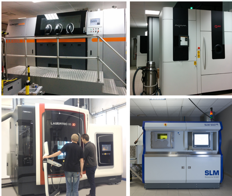
Fig.4 - Concept Laser Xline 1000R, Arcam Q20, SLM Solutions 500 avec 4 lasers et machine hybride Lasertec 65
