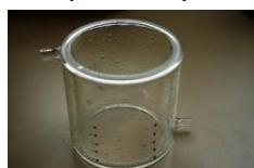
Les doubles enveloppes des réacteurs sont reliées en série afin d'assurer une circulation d'eau provenant du bain marie et permettant la régulation en température du système.
