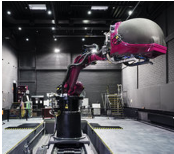
(b) Simulateur « CyberMotion » : MPI for Biological Cybernetics
