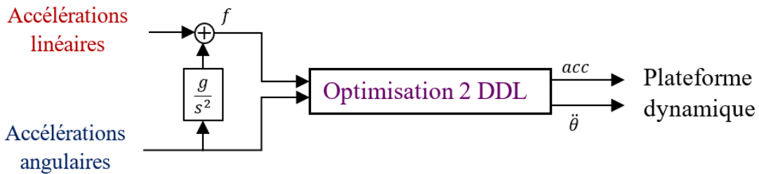
FIGURE 30 – Optimisation de la force spécifique avec deux degrés de liberté.
