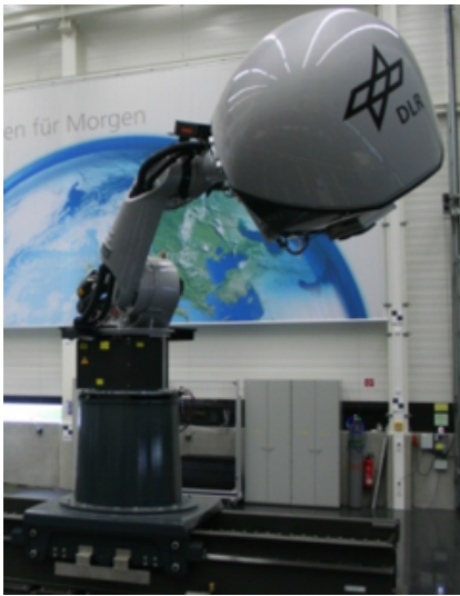
(a) Simulateur en structure série de DLR
