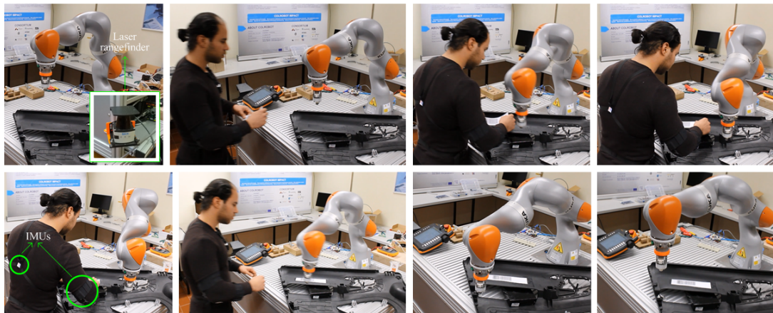
Figure 6.12: L'algorithme d'évitement des collisions développé est mis en œuvre dans une cellule robotique collaborative pour l'assemblage des cartes de portes de voitures (une vidéo montrant l'expérience est en [6]).
