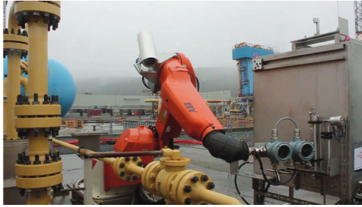
Figure 6.4: Un robot fonctionnant dans un environnement potentiellement explosif, parmi des tuyaux transportant du gaz [4].
