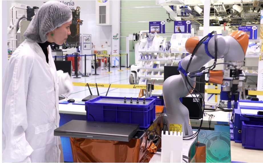
Figure 6.3: KUKA iiwa robot travaillant côte à côte avec un collègue humain dans l'industrie aérospatiale, (Projet ColRobot [3]).
