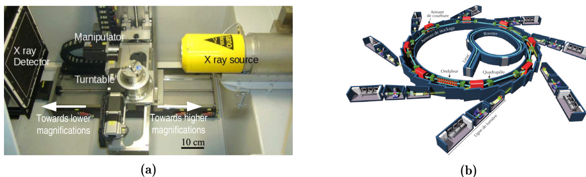
Figure 2.1 – (a) Photographie de l'intérieur d'un tomographe au laboratoire MATEIS [Serrano-Munoz, 2014]. (b) Schéma d'un centre synchrotron [Couprie et al. , 2013]. Les électrons sont produits dans un accélérateur linéaire (LINAC), puis injectés dans le booster pour être accélérés et enfin stockés dans l'anneau de stockage.
