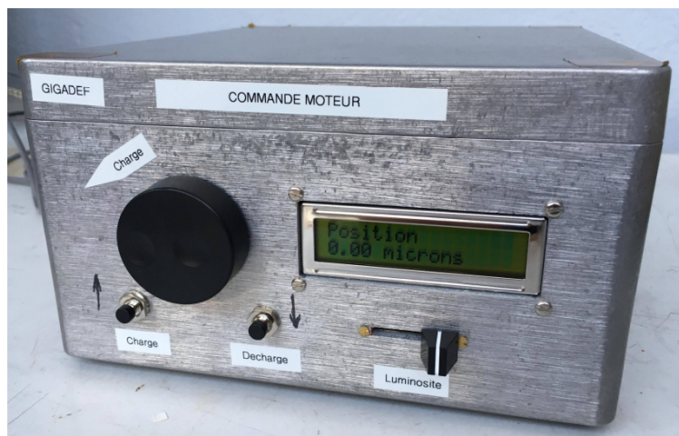
Figure 2.27 – Photographie du boîtier de contrôle du moteur pas à pas.
