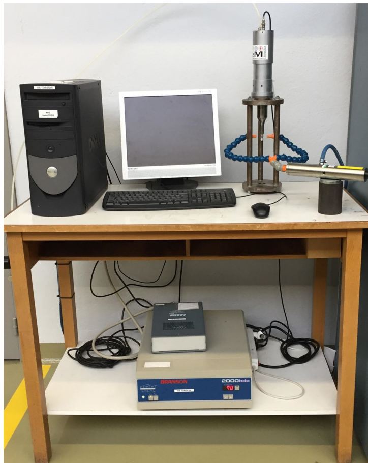
Figure 2.19 – Photographie du dispositif d'essais de fatigue de torsion à 20 kHz.
