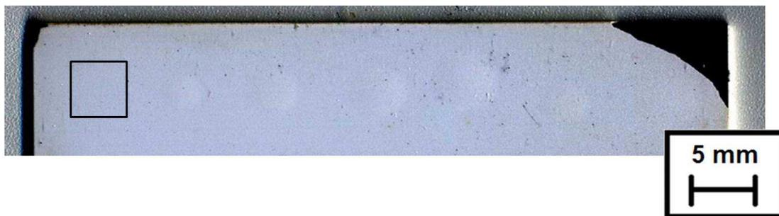
**Figure IV.12 : Image au scanner d'une zone choquée sous seuil de l'échantillon A après un vieillissement à 1100°C de 250 cycles**
