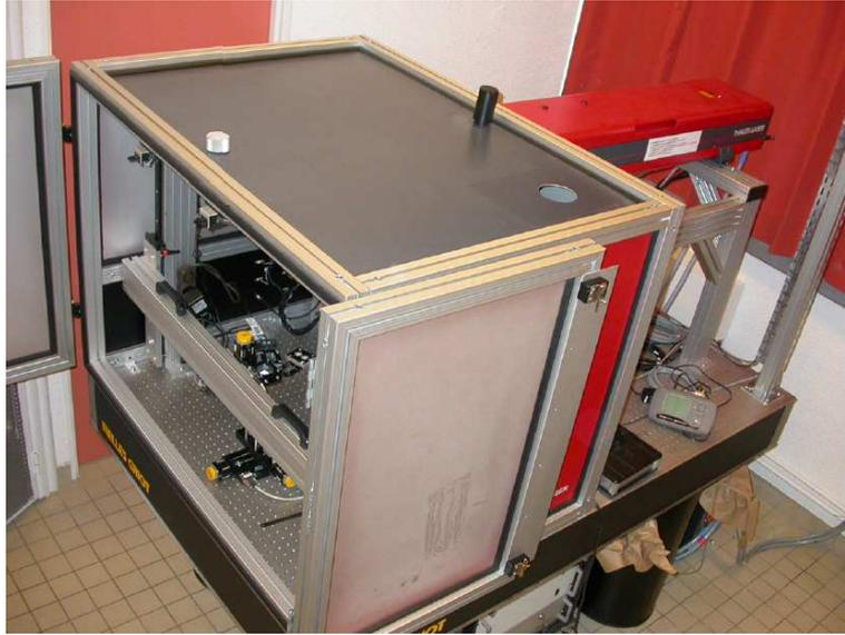
**Figure II.15 : Vue d'ensemble de l'enceinte de tir LASAT du Centre des Matériaux**
