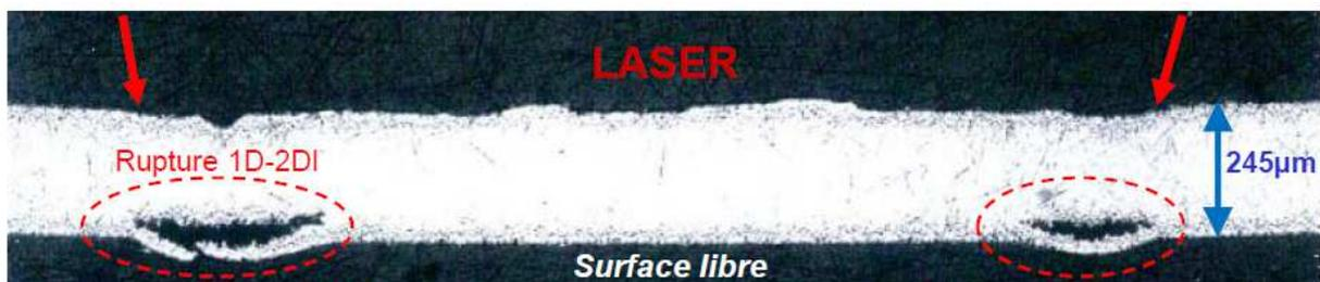
Figure I.28 : Endommagement latéral par choc laser sur titane (LULI 4,8 TW/cm<sup>2</sup>,  $d_{\text{laser}} = 2$  mm, temps d’impulsion du laser 0,3 ns) [CUQ10]
