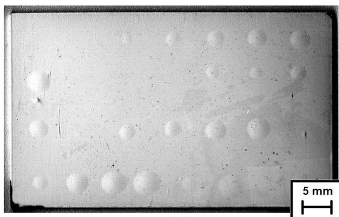
**Figure IV.27 : Image au scanner optique des zones choquées de l'échantillon B avec décohésion après cyclage thermique à 500 cycles (cas d'un échantillon à forte durée de vie)**
