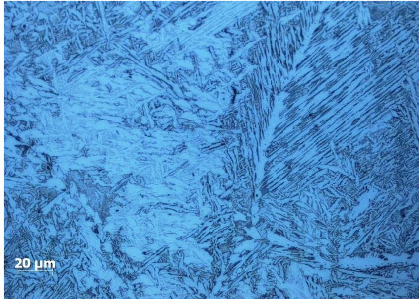
Figure 3-52 : Microstructure du matériau 30C63Al à l'état brut de solidification
