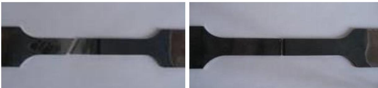
*Figure 4-32 : Gauche : une soudure avec 5% de défaut géométrique ; droite : une soudure avec 15% de défaut géométrique*
