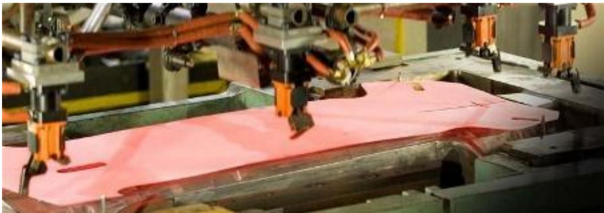
Figure 1-10 : Une pièce chauffée transférée dans les outils d'emboutissage avant la mise en forme<sup>10</sup>
