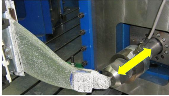
FIGURE 3.24 – Application du chargement sur la lame
