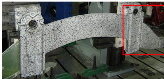
FIGURE 3.23 – Partie de la lame composite où le chargement est appliqué
