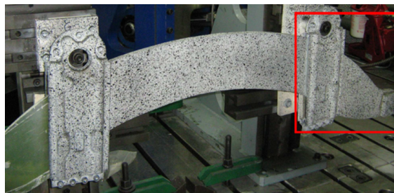
FIGURE 3.23 – Partie de la lame composite où le chargement est appliqué
