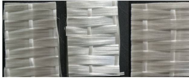
FIGURE 1.32 – Clichés de coupes de trois éprouvettes testées en traction à 90° après pyrolyse
