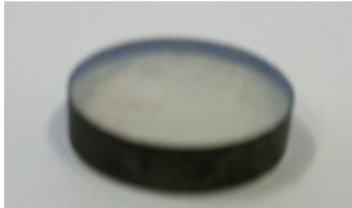
FIGURE 1.24 – Éprouvette de compression dans le sens de l'épaisseur
