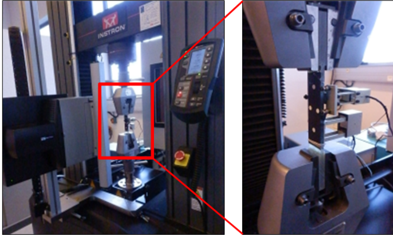
FIGURE 1.14 – Dispositif expérimental des essais de traction à température ambiante
