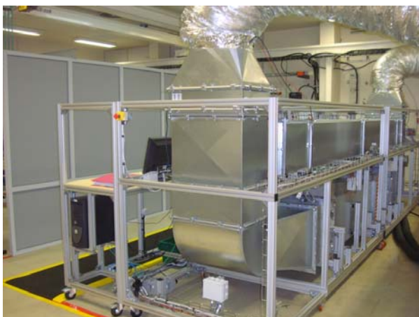
Figure 9: Centrale de traitement d'air du banc d'essai de caractérisation d'échangeurs de chaleur
