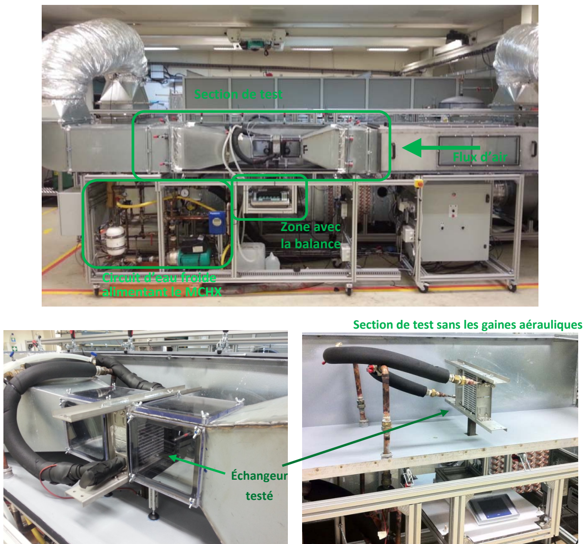
Figure 10: Section de test du banc d'essai de caractérisation d'échangeurs de chaleur
