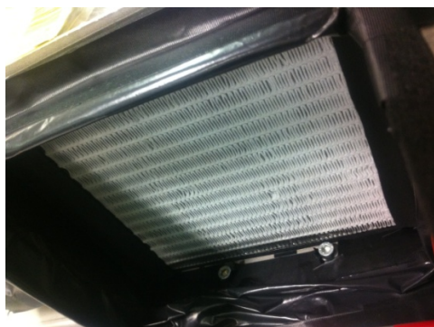
a) Profil de givrage homogène avec débit élevé de fluide
