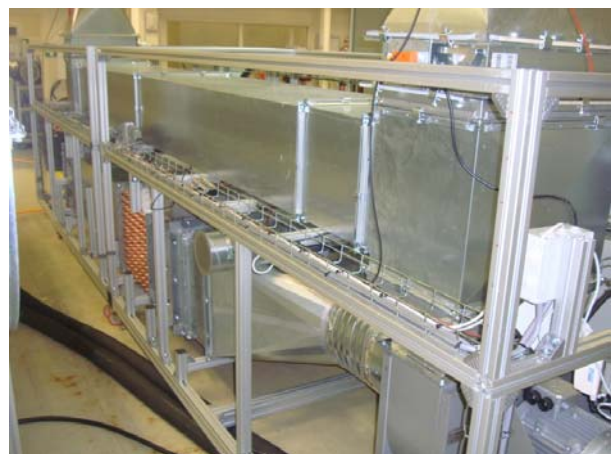
Figure 9: Centrale de traitement d'air du banc d'essai de caractérisation d'échangeurs de chaleur
