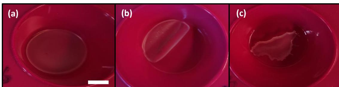
Figure 4.17 : Différents formes obtenues : (a) circulaire (système PMAA-SiN<sup>+</sup> à pH = 9 et RH = 11 %); (b) non circulaire à forme simple (système PMAA-SiN<sup>+</sup> à pH = 6 et RH = 11 %) (c) non circulaire à forme complexe (système PMAA-SiOH à pH = 3 et RH = 33 %). La barre d'échelle représente 1 cm.
