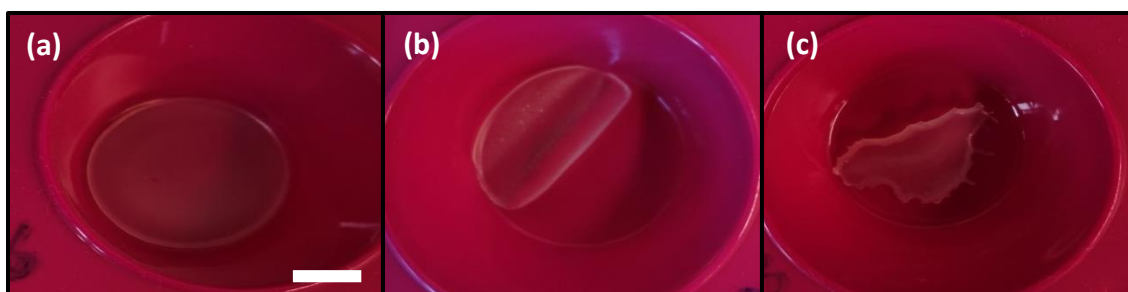
Figure 4.17 : Différents formes obtenues : (a) circulaire (système PMAA-SiN + à pH = 9 et RH = 11 %); (b) non circulaire à forme simple (système PMAA-SiN + à pH = 6 et RH = 11 %) (c) non circulaire à forme complexe (système PMAA-SiOH à pH = 3 et RH = 33 %). La barre d'échelle représente 1 cm.
