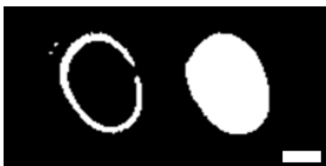
Figure 2.21 : Le programme « Binarisation » déterminant l'aire d'une goutte qui sèche. Ici, l'aire totale de la goutte correspond à tout l'espace blanchi. Exemples issus du séchage de goutte de PMAA à 50 g/L et à pH = 9. Le volume initial est de 0.2 \mu L et la barre d'échelle représente 0.25 mm.
