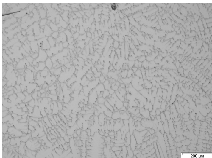
Figure 5.8 : Micrographie optique des dendrites de l'acier UR1 à cœur de lingot après attaque électrochimique à l'acide oxalique 10 % (1,4 V, 200 mA, 1 min)
