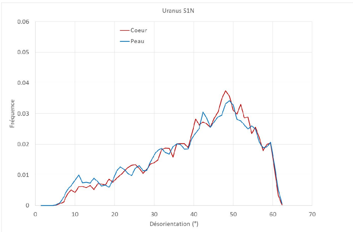
Figure D.5 : Distribution de la désorientation des joints de grains dans l'acier 304L B
