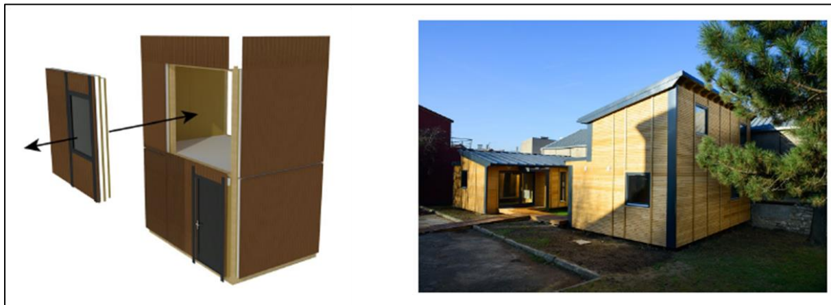
FIGURE 4.1 : PROCÉDE CONSTRUCTIF MODULAIRE D’AGILCARE UTILISE POUR DEUX MAISONS DEMENAGEABLES A MALAKOFF – SOURCE : AGILCARE
