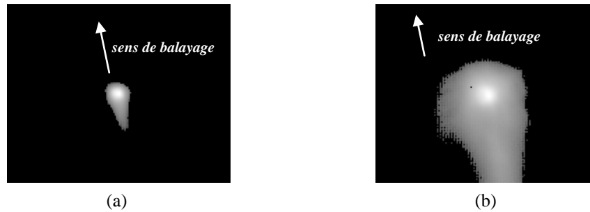
Figure VI-92 : Images thermiques obtenue après suppression du bruit de fond pour le monocordon P175V200AZ80 dans sa zone stable (a) et durant le passage dans l'amas (b) prises au même grandissement
