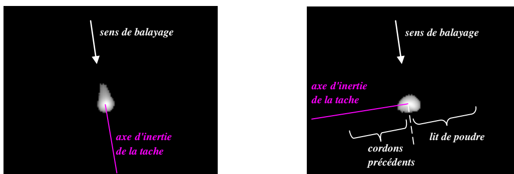
Figure VI-72 : Images thermiques obtenues lors du lasage d'un drap à P175V1750Ev60 : durant le premier cordon (à gauche) et durant le 7 ème , avec recouvrement (à droite)
