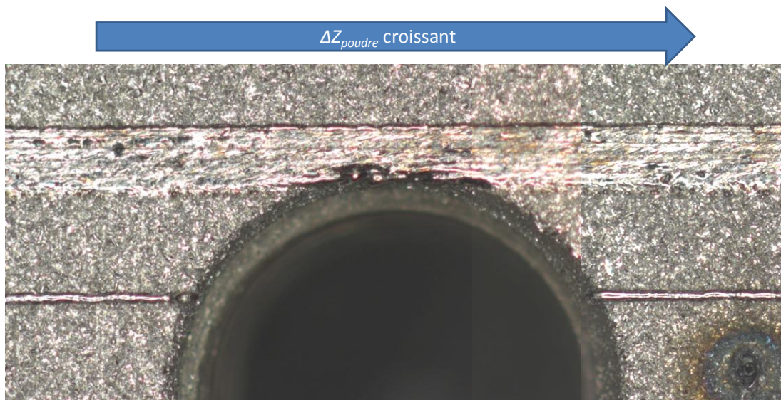
Figure VI-85 : Détail de la trajectoire des fabrications P150V750Mono et P150V750Ev60 se trouvant franchir le trou de vis central du substrat de l'EP2D
