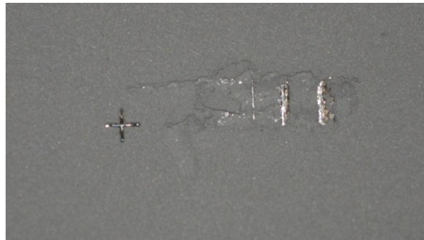
Figure VI-93 : Sillons creusés dans le lit de poudre afin de simuler un défaut de mise en couche
