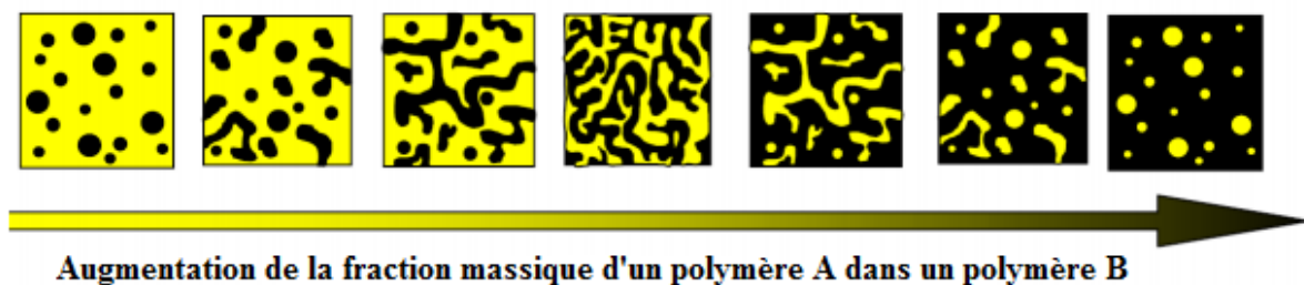
Figure I.2. Evolution de la morphologie en fonction de la fraction massique des composants(31).
