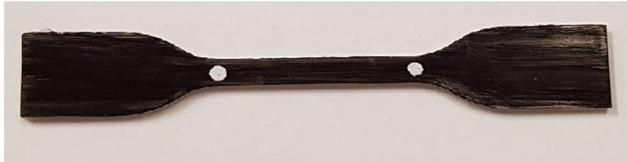
**Figure II.10.** Eprouvette utilisé lors d'un essai de traction.
