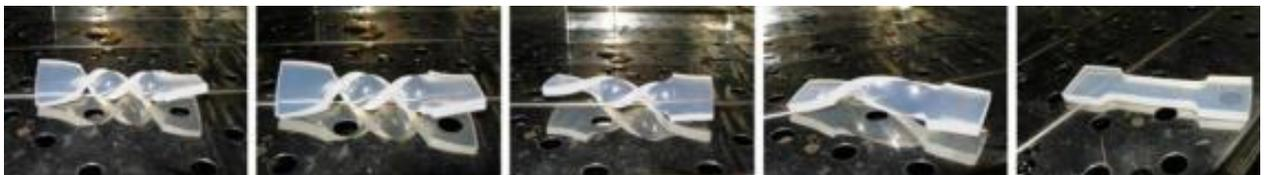
**Figure I.14.** Recouvrement de la forme originale du Veriflex<sup>®</sup> sous l'effet de la chaleur(106).
