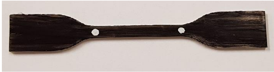
Figure II.10. Eprouvette utilisé lors d'un essai de traction.
