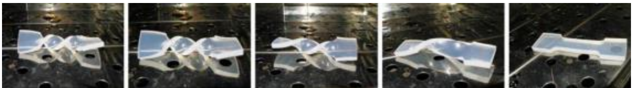
Figure I.14. Recouvreance de la forme originale du Veriflex ® sous l'effet de la chaleur(106).
