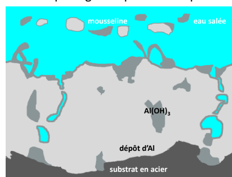
Etape 3 : formation de la mousseline et remplissage des pores du dépôt
