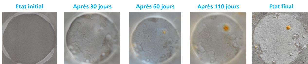
Figure 2-39 Photos de la surface des échantillons en fonction du temps lors de l'essai d'immersion. Le disque observé mesure 20mm de diamètre.
