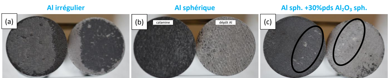
Figure 4-15 Faciès de rupture de dépôt sur substrat BL (Ø=25mm) (a) avec une rupture cohésive de la calamine majoritaire, (b) avec une rupture adhésive dépôt-calamine majoritaire et (c) présentant des petits points de rupture adhésive dépôt-acier (indiqués en noir).
