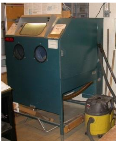
Figure B-4 Sableuse du Centre des Matériaux.
