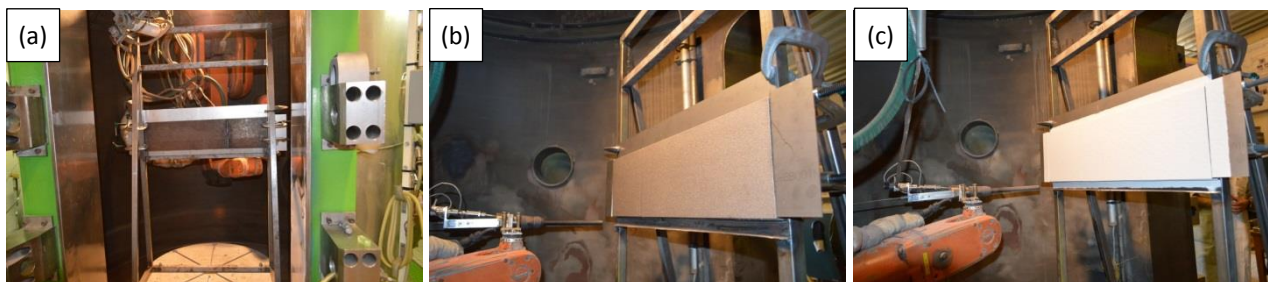
Figure 7-4 (a) Montage de la plaque sur portique dans le CAPS avant projection, et plaque (b) avant et (c) après projection.
