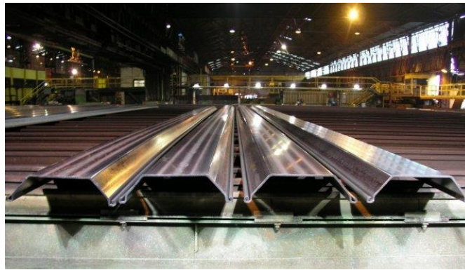
Figure 7-2 Palplanche de section en U sur lit de refroidissement après laminage [PAL17].
