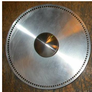
Figure 2-23 Disque troué de 149,5mm de diamètre, placé dans le distributeur de poudre. Chaque trou mesure 2,9mm de diamètre.
