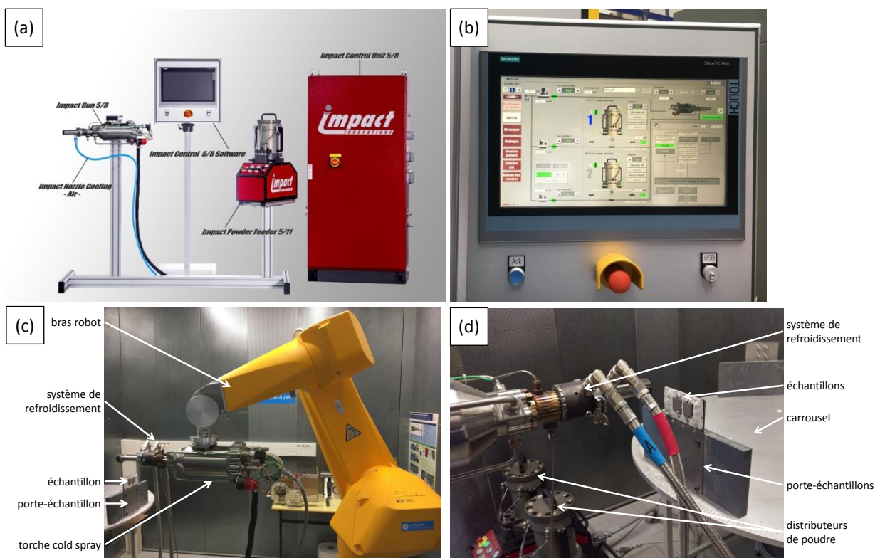
Figure 7-12 (a) Composants l'installation cold spray 5/8 produite par Impact Innovations [IMP00], (b) tableau de commande du cold spray de l'INSA Lyon, (c) et (d) pistolet cold spray dans l'enceinte insonorisée.
