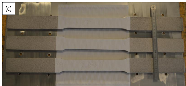
Figure 7-6 (a) Schéma et (b) dimensions de l'éprouvette de traction, et (c) photos des éprouvettes revêtues.
