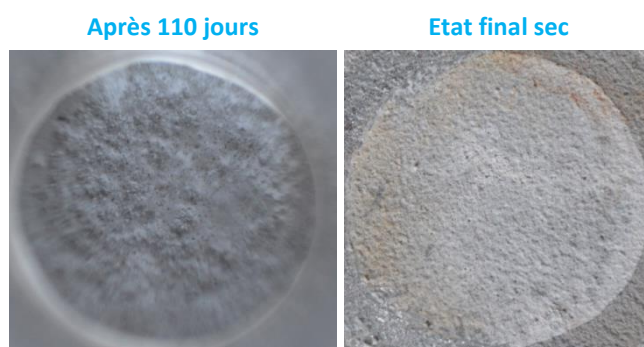
Figure 6-8 Vues de dessus en photo optique de la surface corrodée ( \varnothing=20\text{mm} ) d'un dépôt d'Al irrégulier (campagne de projection de 2015) après 110 jours d'essai, avant et après séchage.
