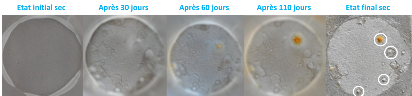
Figure 6-12 Vues de dessus en photo optique de l'évolution au cours de l'essai d'immersion de plusieurs cloques (entourées en blanc à l'état final) à la surface ( \varnothing=20\text{mm} ) d'un dépôt d'Al sphérique sur substrat BL (campagne de projection de 2015).
