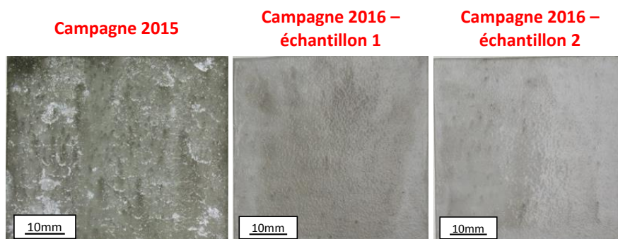
Figure 6-22 Vues de dessus en photo optique du comportement en brouillard salin d'un dépôt d'Al sph. +15%pds Al 2 O 3 sph. après 35 jours d'essai en fonction de la campagne d'essai et de l'échantillon observé.
