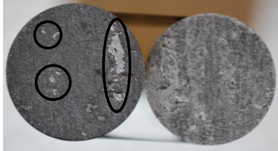
Figure 4-16 Faciès de rupture mixte adhésive-cohésive avec des écailles d'un dépôt d'Al sph. +30%pds Al 2 O 3 ang. sur substrat BL (Ø=25mm).
