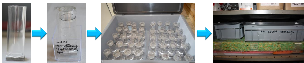
Figure 2-38 Description de l'essai d'immersion.
