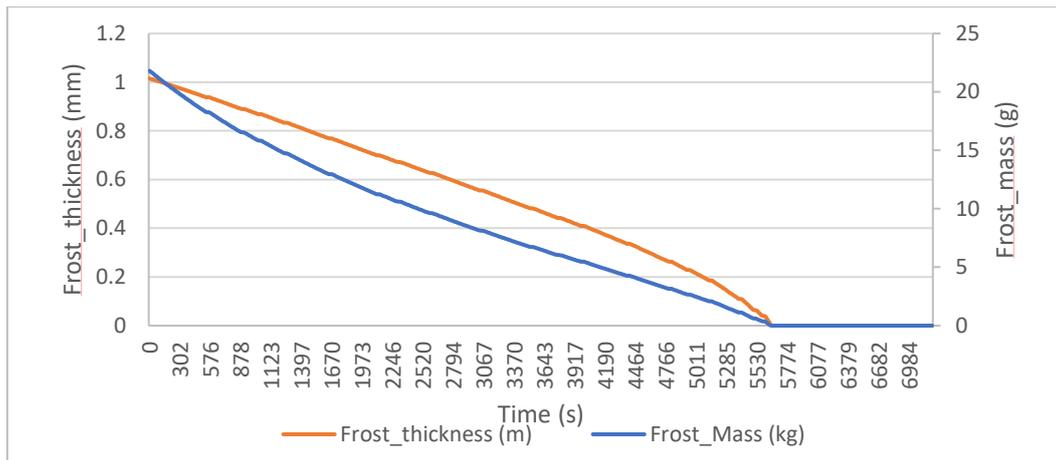
Figure F26: Evolution de la masse et de l'épaisseur du givre pendant la phase de dégivrage pour le Cas 1
