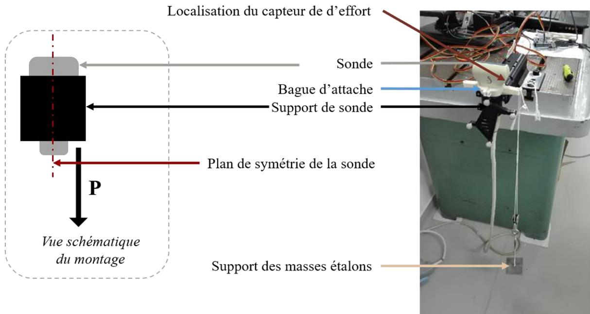
Figure 101 : Montage expérimental pour l'estimation de l'impact d'un chargement asymétrique de l'instrumentation sur les mesures d'efforts.  $P$ , sur la vue schématique indique la direction du poids appliqué à l'instrumentation via les masses étalons.
