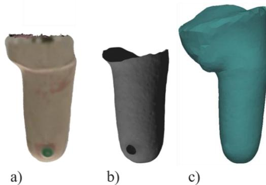
Figure 62 : (a) Reconstruction du plâtre rectifié obtenu à partir du scanner optique, (b) géométrie de l'emboîture déduite de la géométrie du plâtre et (c) géométrie du membre résiduel également issue du modèle du plâtre.
