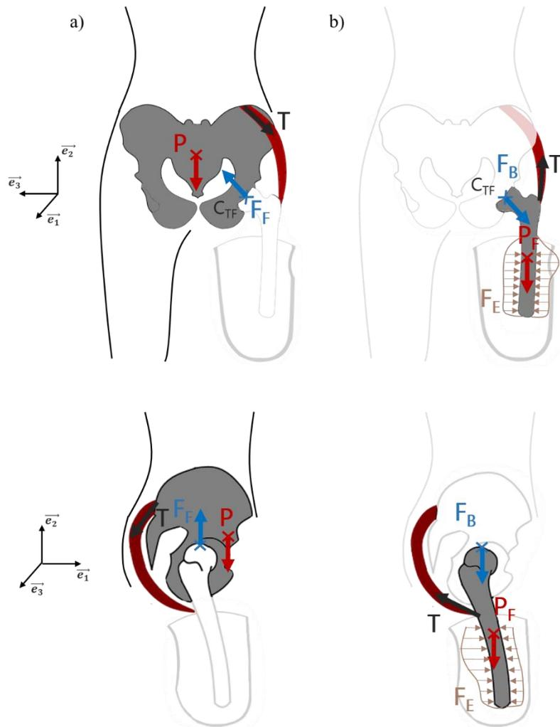
Figure 18 : Bilan des actions mécaniques appliquées sur le bassin (a), sur le fémur (b) dans le plan frontal et le plan sagittal.
