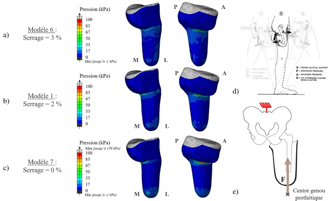
Figure 83 : Comparaison des répartitions de pressions pour différentes valeurs de serrages (a, b et c). Le chargement imposé correspondait à l'effort vertical (e) calculé pour 25 % du cycle de marche (d). M indique la face médiale du membre résiduel, L la face latérale, P la face postérieure et A la face antérieure.
