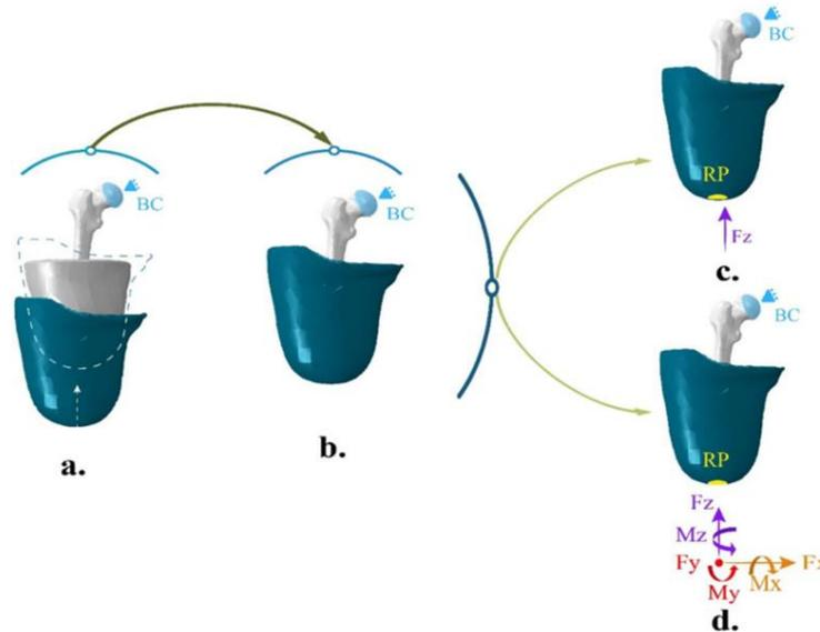
Figure 30 : Conditions limites du modèle de (Henao et al., 2020). (a) Phase de donning, (d) application du chargement en dynamique pendant la marche, (c) application de l'effort bipodal. Issue de (Henao et al., 2020).
