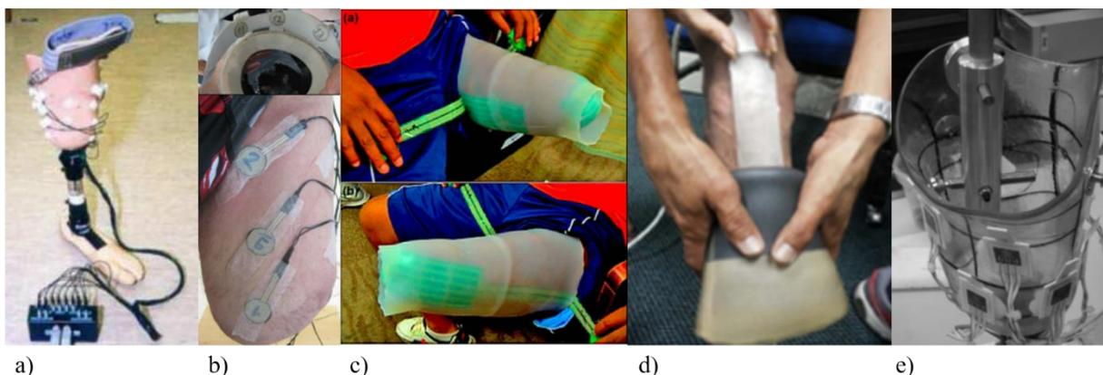
Figure 23 : Technologies pour la mesure des pressions appliquées sur le membre résiduel. (a) capteurs d'effort présentés par (Goh et al., 2005), (b) capteurs FSR issus de (Moineau, 2017), (c) nappes de pression utilisées par (Kahle et al., 2014), (d) capteurs fibre optique de (Al-Fakih, Abu Osman, Mahmad Adikan, et al., 2016) et (e) jauges de déformation sur emboîture par (Sewell et al., 2012).
