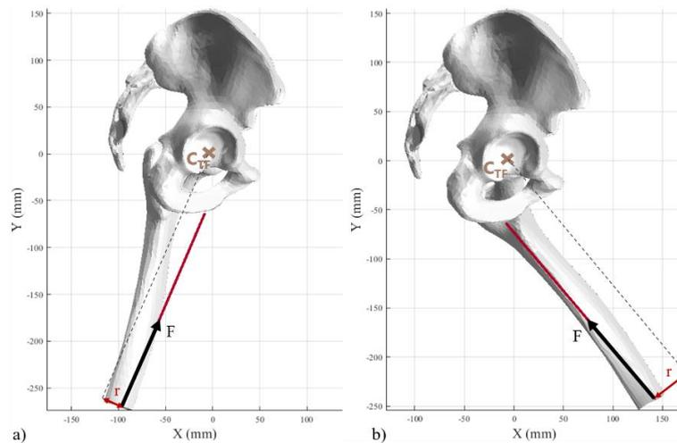
Figure 48 : Bras de levier du muscle gracile dans deux positions de hanche : en extension (a) et en flexion(a). Lorsque la hanche est en flexion, par exemple de 50° (b), le bras de levier calculé pour cette position de muscle implique un moment d'extension de hanche ce qui va à l'encontre du rôle de fléchisseur du gracile. Dans ce cas le bras de levier était forcé à la valeur nulle.
