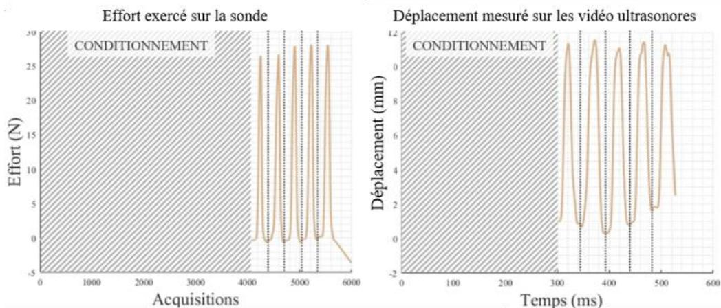
Figure 34 : Courbes expérimentales obtenues en effort et déplacement. La zone hachurée masque les cycles ayant servi au conditionnement des tissus. Les traits verticaux indiquent les limites entre les différents cycles de chargement/déchargement.
