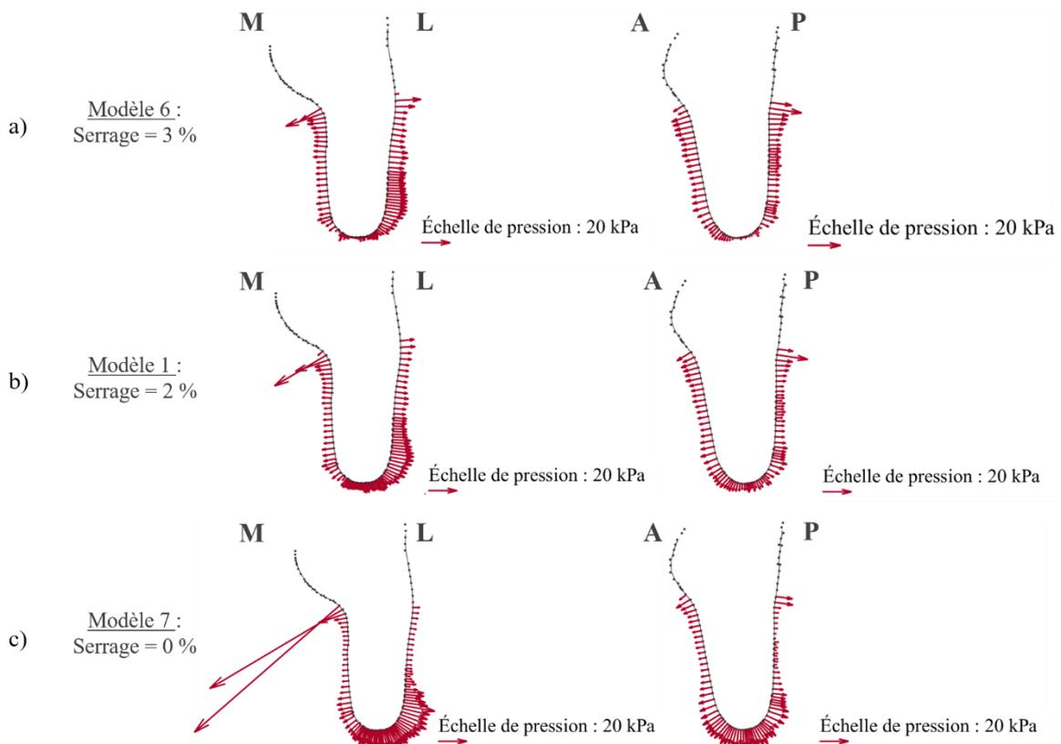
Figure 84 : Comparaison des profils antéro-postérieur et médio-latéral de pressions pour différentes valeurs de serrage de l'emboîture (a, b et c). M indique la face médiale du membre résiduel, L la face latérale, P la face postérieure et A la face antérieure.
