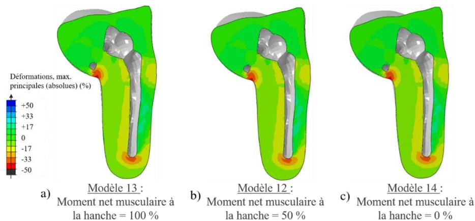
Figure 96 : Déformation principale maximale des tissus mous dans le plan frontal du membre résiduel pour les différentes valeurs de moment repris par l'appui ischiatique.
