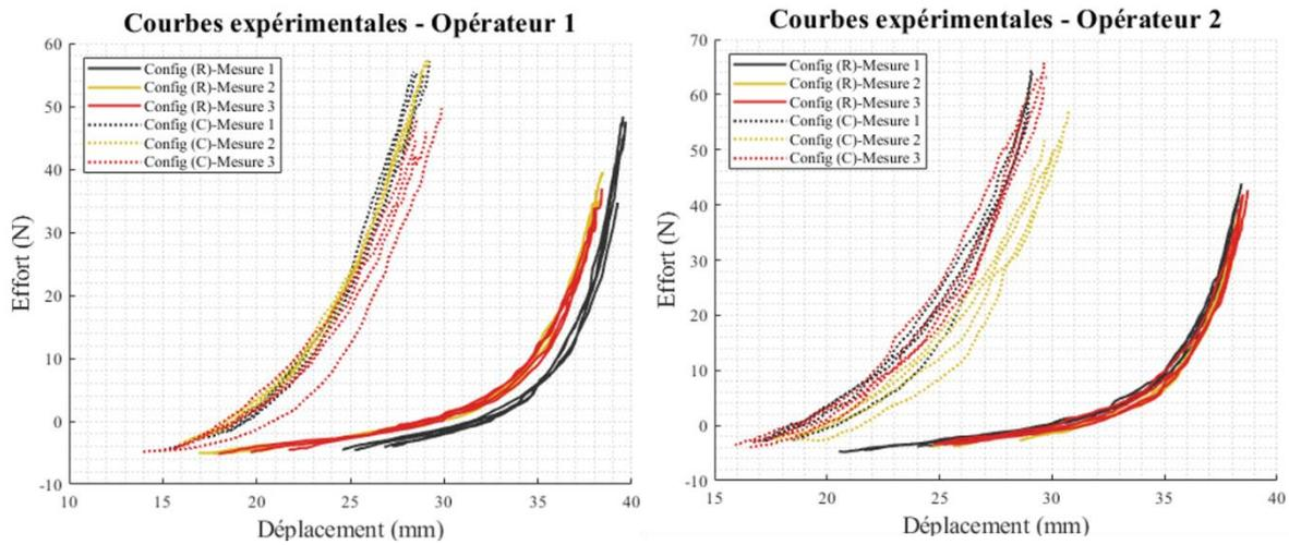
Figure 35 : Courbes expérimentales d'effort-déplacement pour les deux opérateurs dans les configuration (R) et (C) pour un des sujets non amputés. Chaque cycle d'indentation réalisé par l'opérateur est représenté par une couleur différente.
