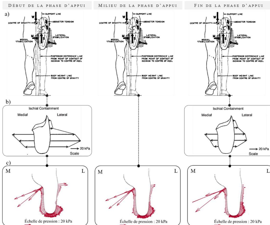
Figure 76 : Comparaison des profils de pression durant la marche appareillée dans le plan frontal tels que décrits par Radcliffe (a), avec les mesures réalisées par Lee et al. 1997 (b) ainsi qu'avec les résultats des simulations de la présente étude (c). Les mesures présentées en (b) correspondent aux profils de pression pour 10 % et 50 % du cycle de marche. M = face médiale, L = face latérale, A = face antérieure, P = face postérieure.
