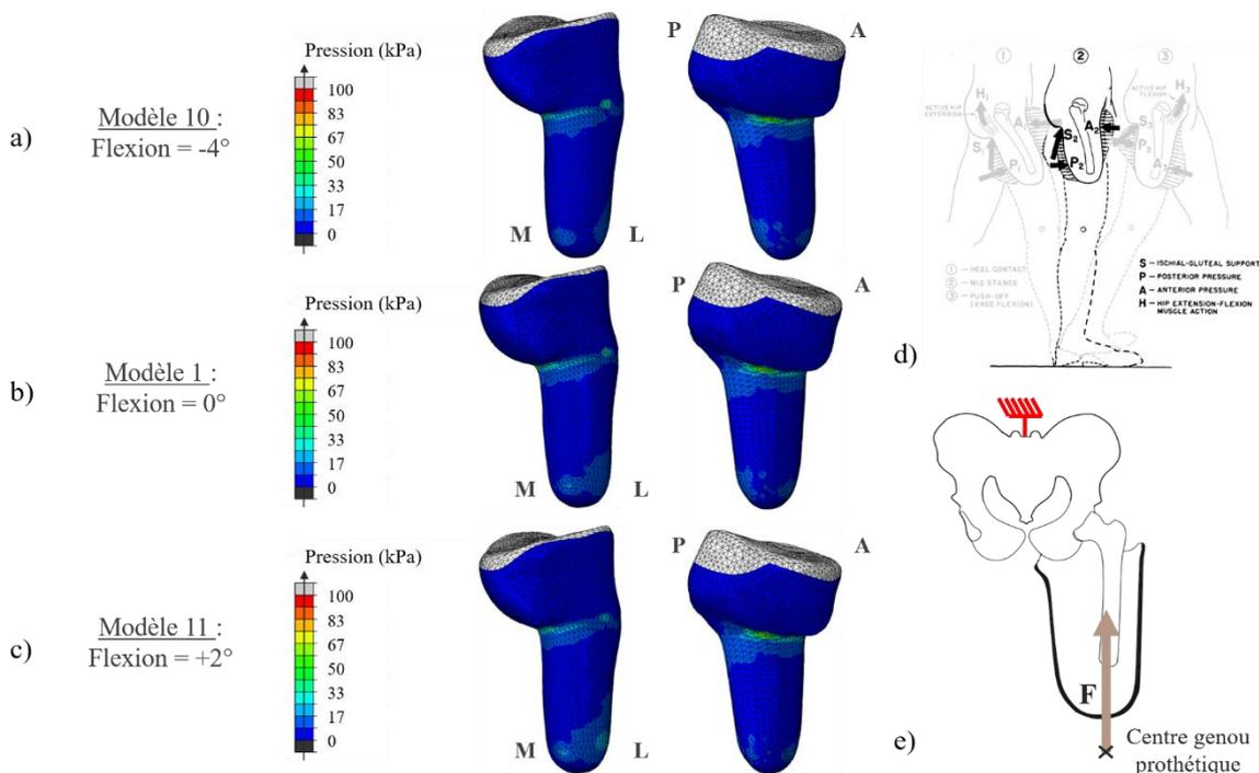
Figure 91 : Comparaison des répartitions de pressions pour différentes valeurs de flexion du fémur (a, b et c). Le chargement imposé correspondait à l'effort vertical (e) calculé pour 25 % du cycle de marche (d). M indique la face médiale du membre résiduel, L la face latérale, P la face postérieure et A la face antérieure.
