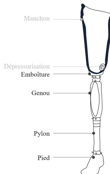
*Figure 5 : Prothèse transfémorale composée d'une emboîture, d'un genou et d'un pied prothétique ainsi que d'éléments de liaison comme le pylon. Un manchon peut être placé entre l'emboîture et le membre résiduel. Un système d'attache peut éventuellement être ajouté par le biais d'une sangle, d'un manchon à accroche distale ou par une valve de dépressurisation.*
