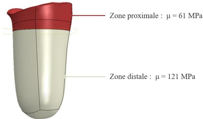
Figure 61 : Caractéristiques mécaniques de la zone distale de l'emboîture en beige et de la zone proximale en rouge.
