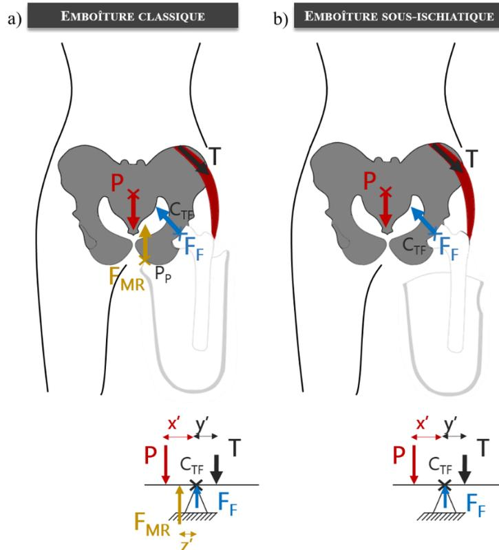
Figure 19 : Actions mécaniques agissant sur le moment d'abduction de la hanche pour les emboîtures classiques (quadrilatérale ou à ischion intégré) (a) et une emboîture sous ischiatique (b).
