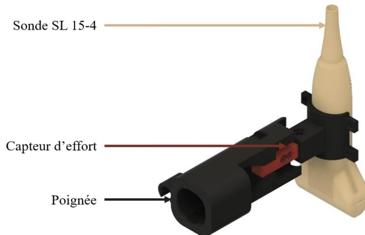
Figure 31 : Montage de l'indenteur réalisé en combinant un capteur de force et une sonde ultrasonore.
