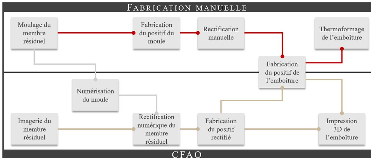
Figure 9 : Comparaison des processus de fabrication de l'emboîture : méthode manuelle et méthode numérique. Les deux méthodes ne sont pas nécessairement indépendantes. Les outils numériques sont parfois mis en application au cours du processus manuel de fabrication de l'emboîture. Adaptée de (Berke et al., 2007).
