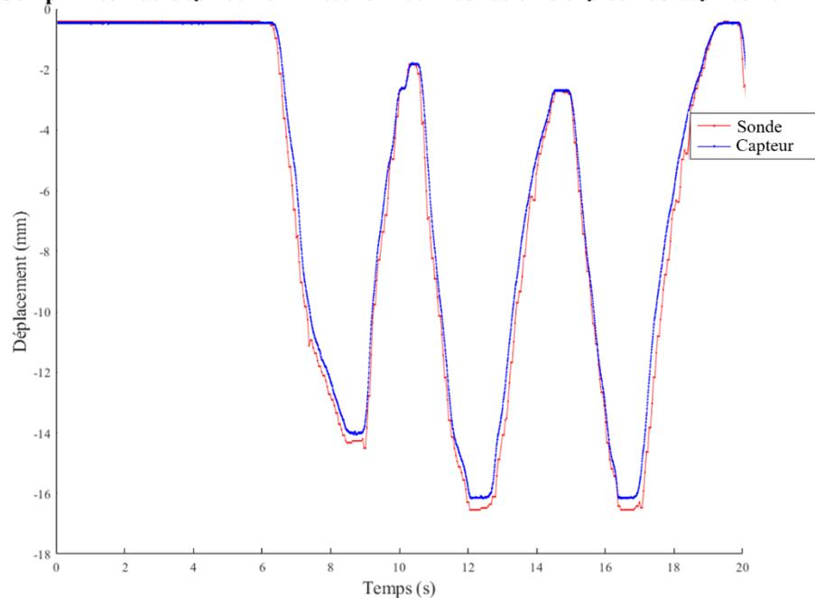
Figure 103 : Comparaison de la mesure de déplacement obtenue avec la sonde ultrasonore (rouge) et avec le capteur de déplacement (bleu).
