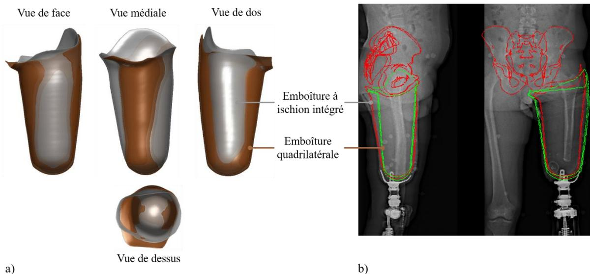
Figure 79 : Géométries des emboîtures obtenues avec OrtenShape (a) et (b) recalage de ces emboîtures sur les raadiographies biplanaires
