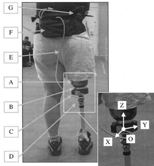
Figure 42 : Montage d'un capteur de force (B) entre le tibia prothétique (D) et l'emboîture (A). Issue de (Frossard et al., 2003)
