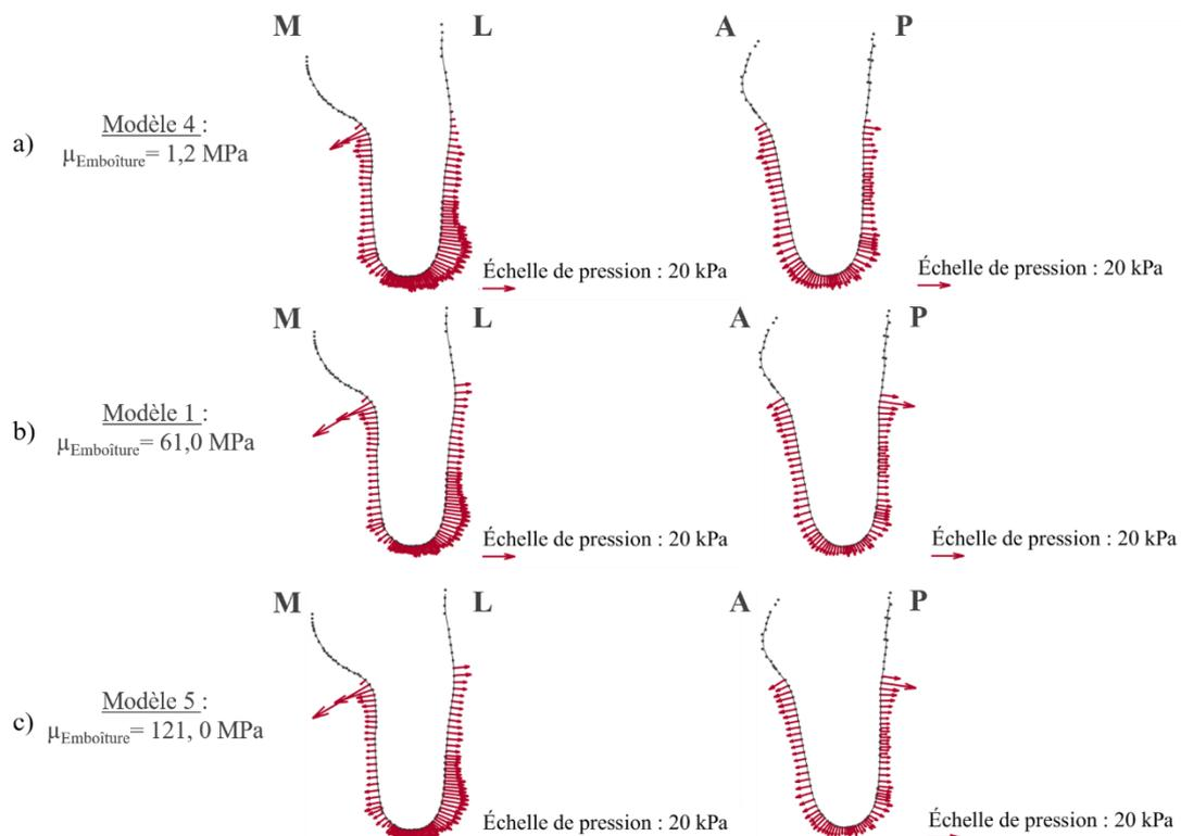
Figure 87 : Comparaison des profils antéro-postérieur et médio-latéral de pressions pour différentes valeurs de module de cisaillement du bord proximal de l'emboîture (a, b et c). M indique la face médiale du membre résiduel, L la face latérale, P la face postérieure et A la face antérieure.
