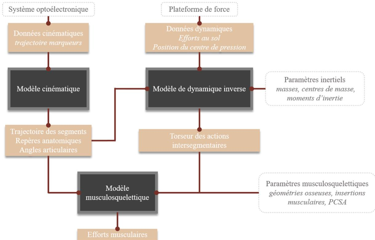
Figure 43 : Estimation des efforts musculaire à partir d'un modèle musculosquelettique. PCSA : physiological cross-sectional area. Adaptée de (Camomilla et al., 2017)
