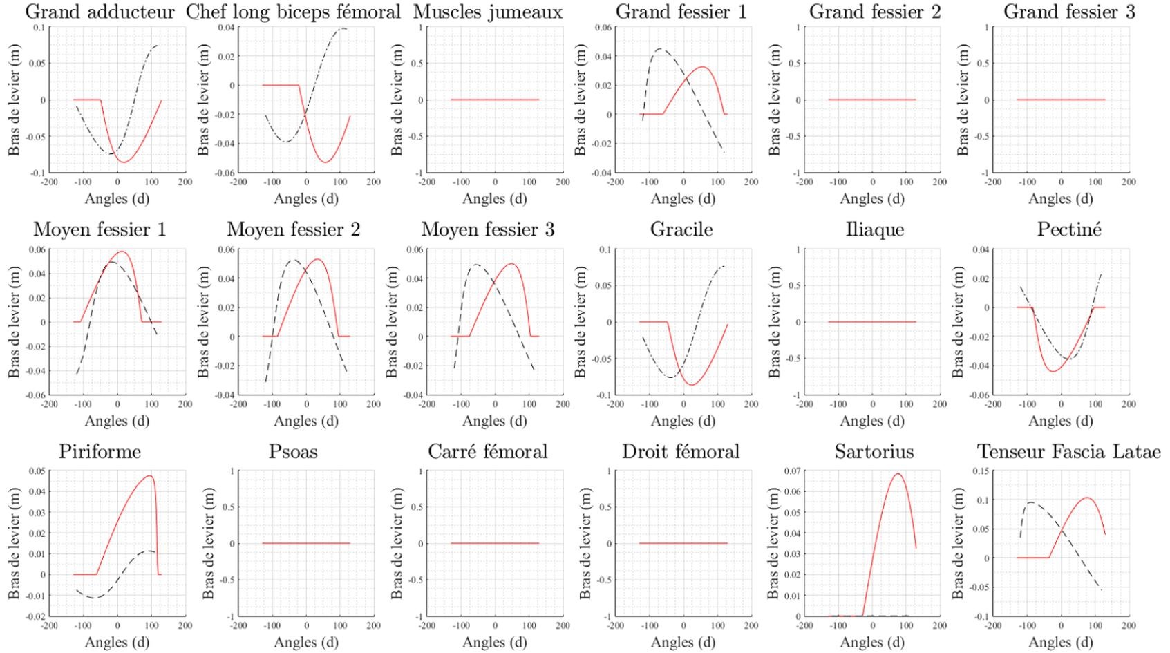
Figure 52 : Comparaison de l'estimation des bras de leviers par OpenSim (en noir) et de l'estimation du modèle musculosquelettique de l'étude pour un sujet désarticulé du genou de la base BD-1 (en rouge) dans le plan frontal.
