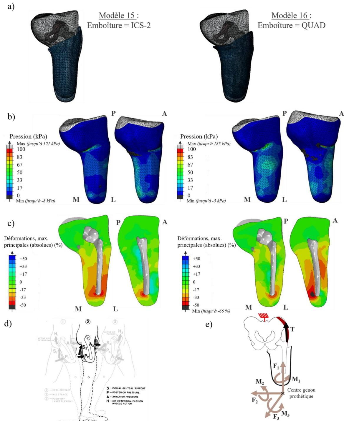
Figure 97 : Résultats des simulations pour les emboîture ICS-2 et QUAD. (a) Géométrie du modèle à la fin des simulations, (b) pressions appliquées au membre résiduel dans le plan frontal et sagittal, (c) déformations maximales principales dans les tissus mous dans le plan frontal et sagittal. Le chargement imposé correspondait à l'ensemble du torseur (e) à 25 % du cycle de marche (d). M indique la face médiale du membre résiduel, L la face latérale, P la face postérieure et A la face antérieure.
