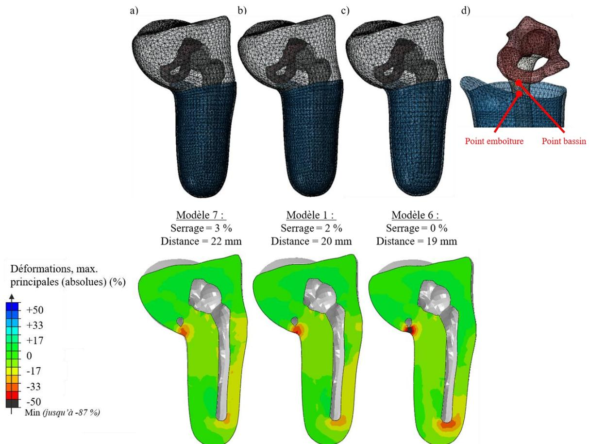
Figure 85 : Comparaison de l'enfoncement et de déformations logarithmiques maximales principales du membre résiduel dans l'emboîture selon les différents modèles (a, b, c). La distance était mesurée sur Abaqus entre les deux points indiqués en (d).
