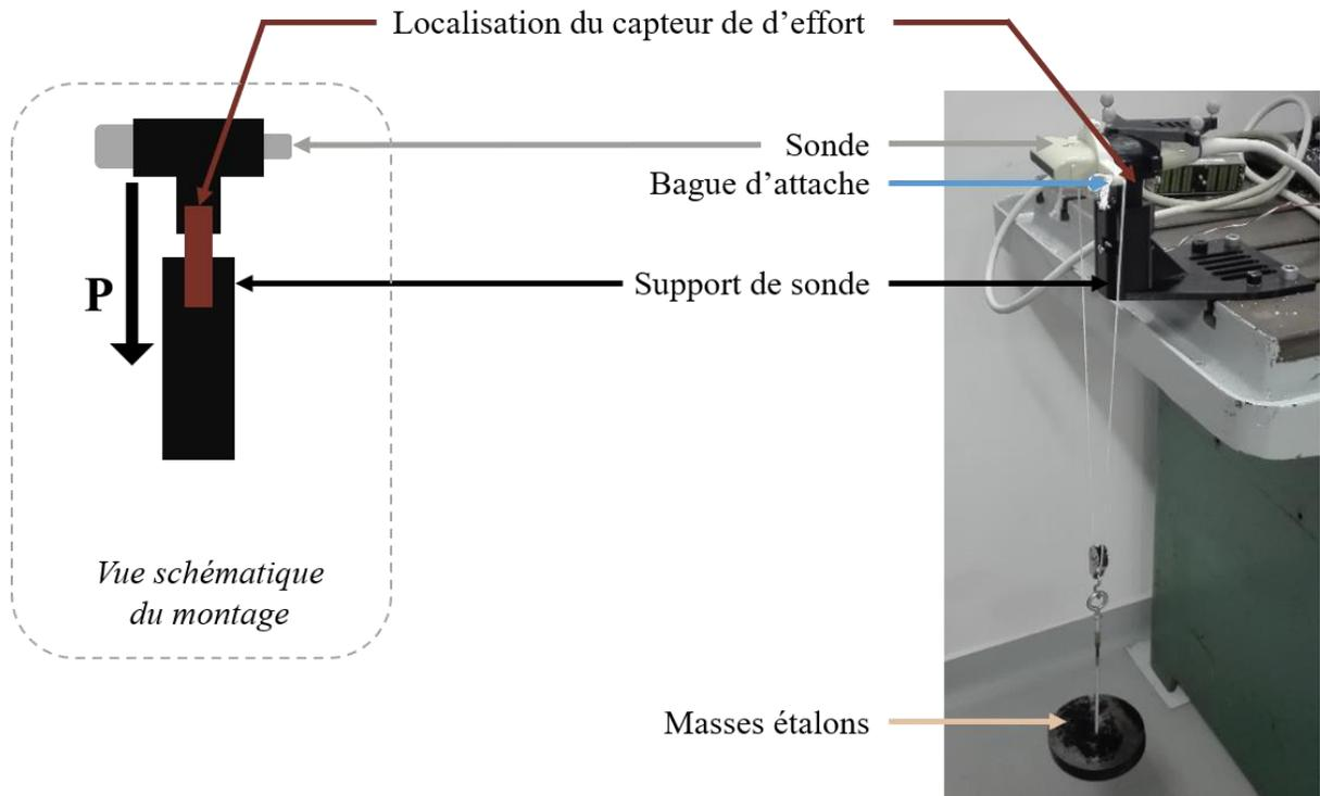
Figure 102 : Montage expérimental pour l'estimation de l'impact d'un chargement perpendiculaire à la sonde sur les mesures d'effort. *P*, sur la vue schématique indique la direction du poids appliqué à l'instrumentation via les masses étalons.
