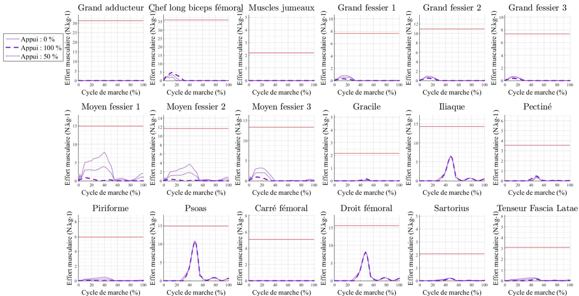
Figure 56 : Efforts musculaires estimés pour le sujet 03 (membre résiduel moyen), pour trois conditions d'appui : 0 % d'appui ischiatique, 50 % d'appui ischiatique et 100 % d'appui ischiatique
