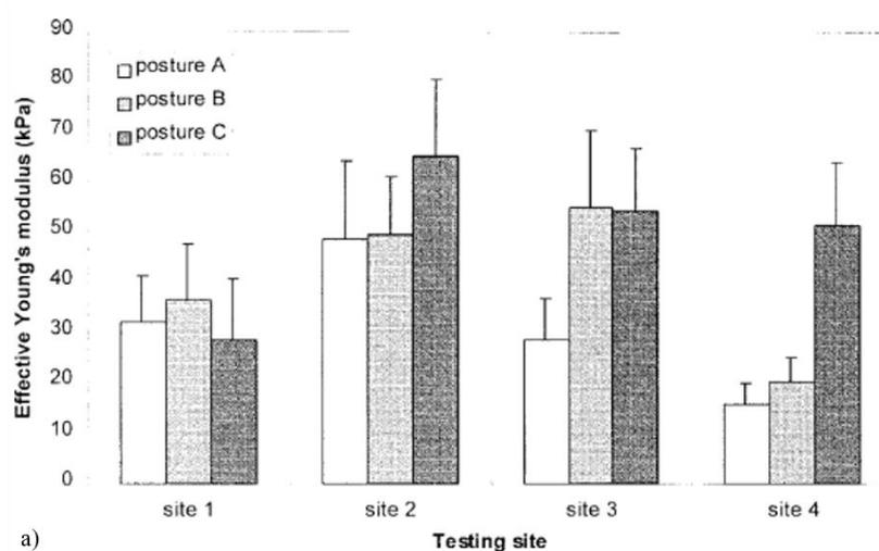
Figure 26 : Module d'Young équivalent des tissus mous, sur quatre zones distinctes du mollet, sur huit sujets pour trois postures différentes. D'après (Zhang et al., 1999).
