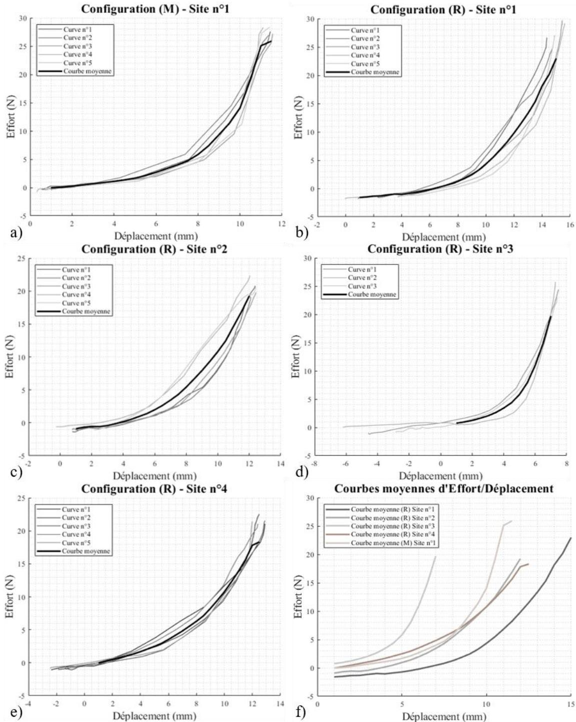
Figure 36 : Ensemble des courbes expérimentales d'effort/déplacement pour la configuration (M) (a) et la configuration (R) pour les quatre sites d'indentation (b-e) pour les mesures réalisées avec le sujet amputé. Les courbes moyennes des réponses par site et configuration sont présentés en (f). Pour la figure (d), deux courbes aberrantes ont préalablement été exclues.
