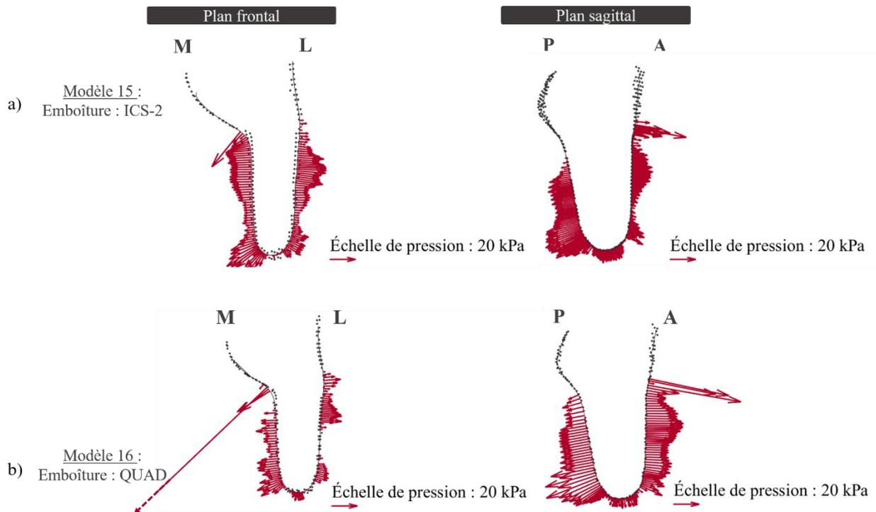
Figure 98 : Comparaison des profils de pression dans le plan sagittal et dans le plan frontal pour une emboîture à ischion intégré ICS-2(a) et une emboîture quadrilatérale QUAD(b). La flèche en pointillé indique que l'amplitude de pression était trop importante pour être représentée avec cette échelle.
