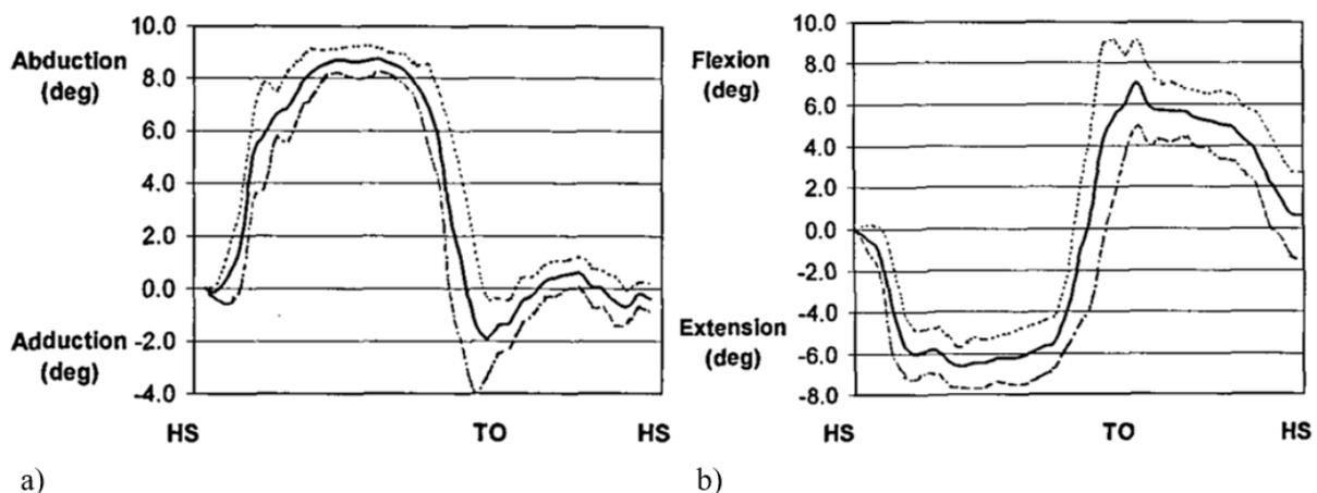
Figure 29 : Mouvement relatif du fémur dans l’emboîture au cours du cycle de marche (HS : heel strike, TO : toe off) (a) en dans le plan frontal et (b) dans le plan sagittal. D’après (Convery et al., 2000)
