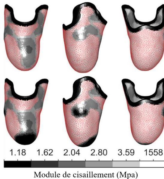
Figure 27 : Emboîture tibiale en matériaux composites dont le module de cisaillement varie en fonction de la région. D'après (Moerman et al., 2016)
