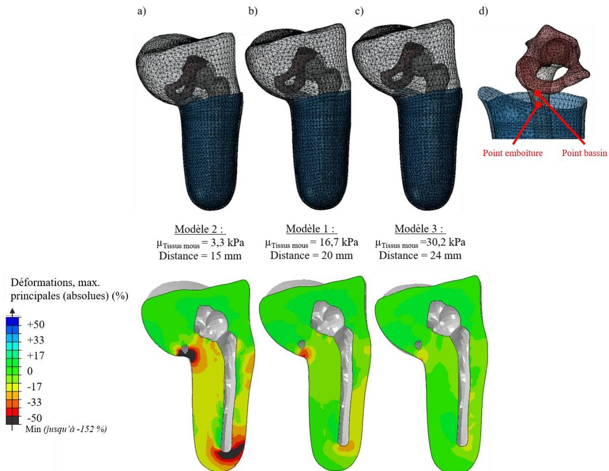
Figure 82 : Comparaison de l'enfoncement et des déformations logarithmiques maximales principales du membre résiduel dans l'emboîture selon les différents modèles (a, b, c). La distance était mesurée sur Abaqus entre les deux points indiqués en (d).
