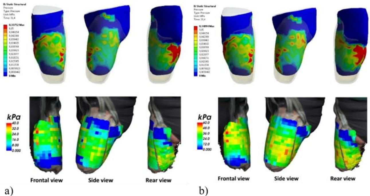
Figure 25 : Comparaison entre simulations éléments finis et mesures de pression pour un chargement équivalent à 50 % du poids du sujet (a) et un chargement égal au poids du sujet (b). D'après (Colombo et al., 2016)
