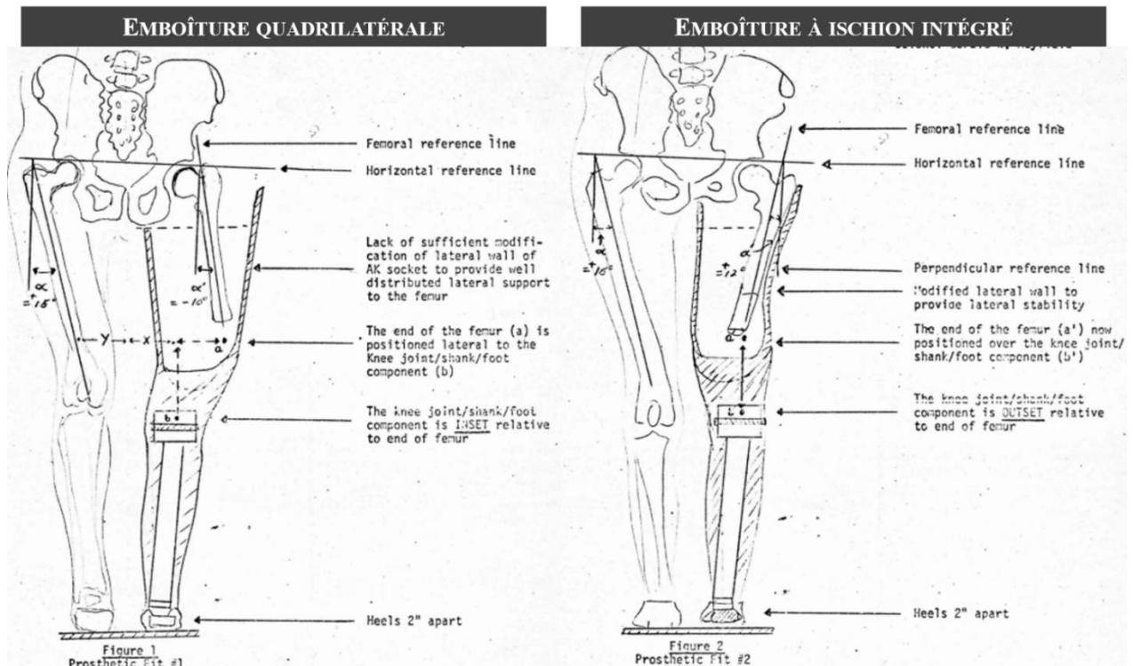
Figure 16 : Abduction du fémur dans l'emboîture lors de l'appui bipodal d'un sujet avec une emboîture quadrilatérale et d'un sujet avec une emboîture à ischion intégré. Adaptée de (Mayfield et al., 1977).
