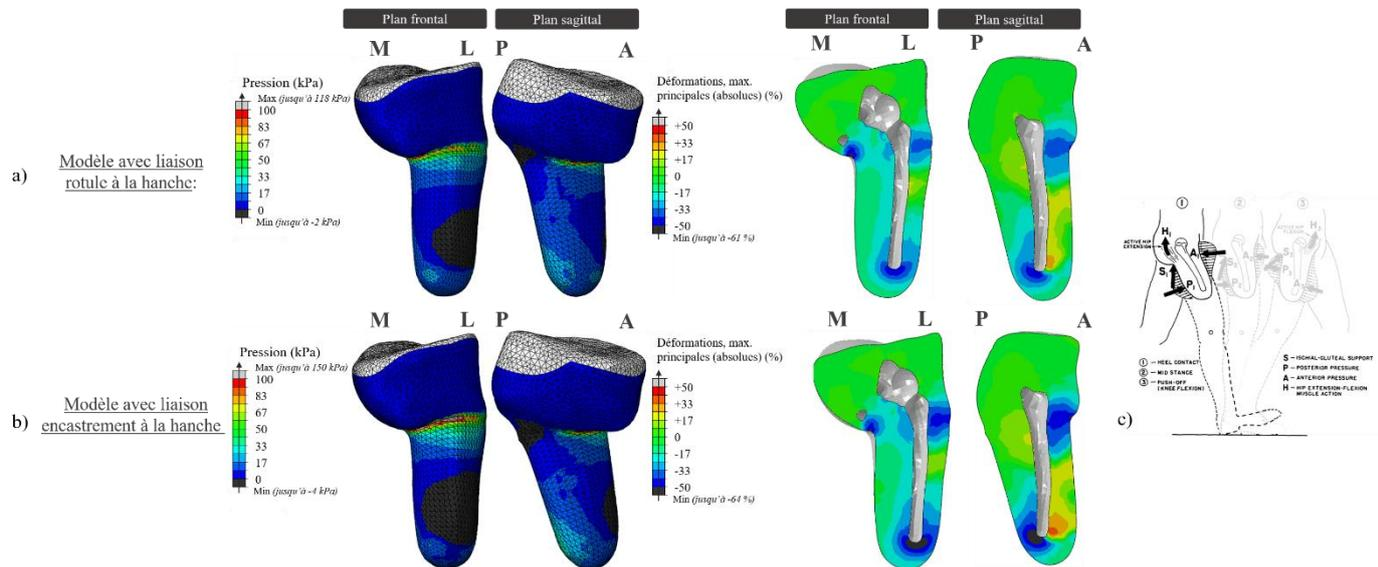
Figure 74 : Comparaison des répartitions de pression et des déformations maximales principales entre un modèle représentant la liaison coxo-fémorale par une rotule (a) et un modèle la représentant par une liaison encastrement (b). Le chargement appliqué à l'emboîture correspond au torseur des actions mécaniques calculé pour 15 % du cycle de marche.
