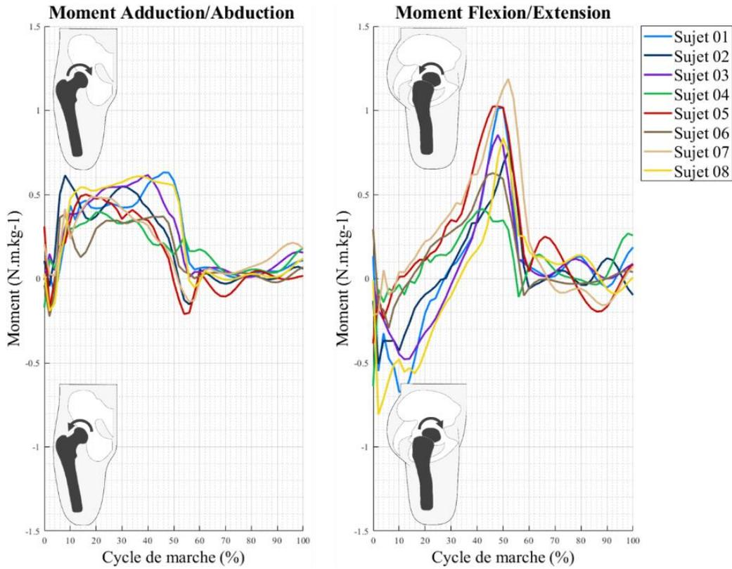
Figure 49 : Moments résultants d'abduction et de flexion de la hanche exprimés au centre de la tête fémorale obtenus grâce à la méthode de la dynamique inverse pour les huit sujets de l'étude.
