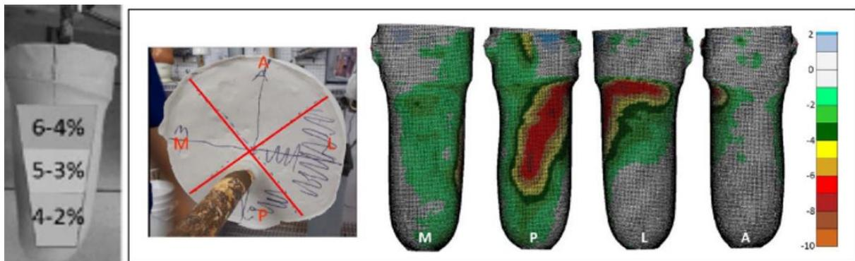
Figure 20 : Serrage et schéma de rectification appliqué aux emboîtures NU-FlexSIV et NU-FlexSIS
