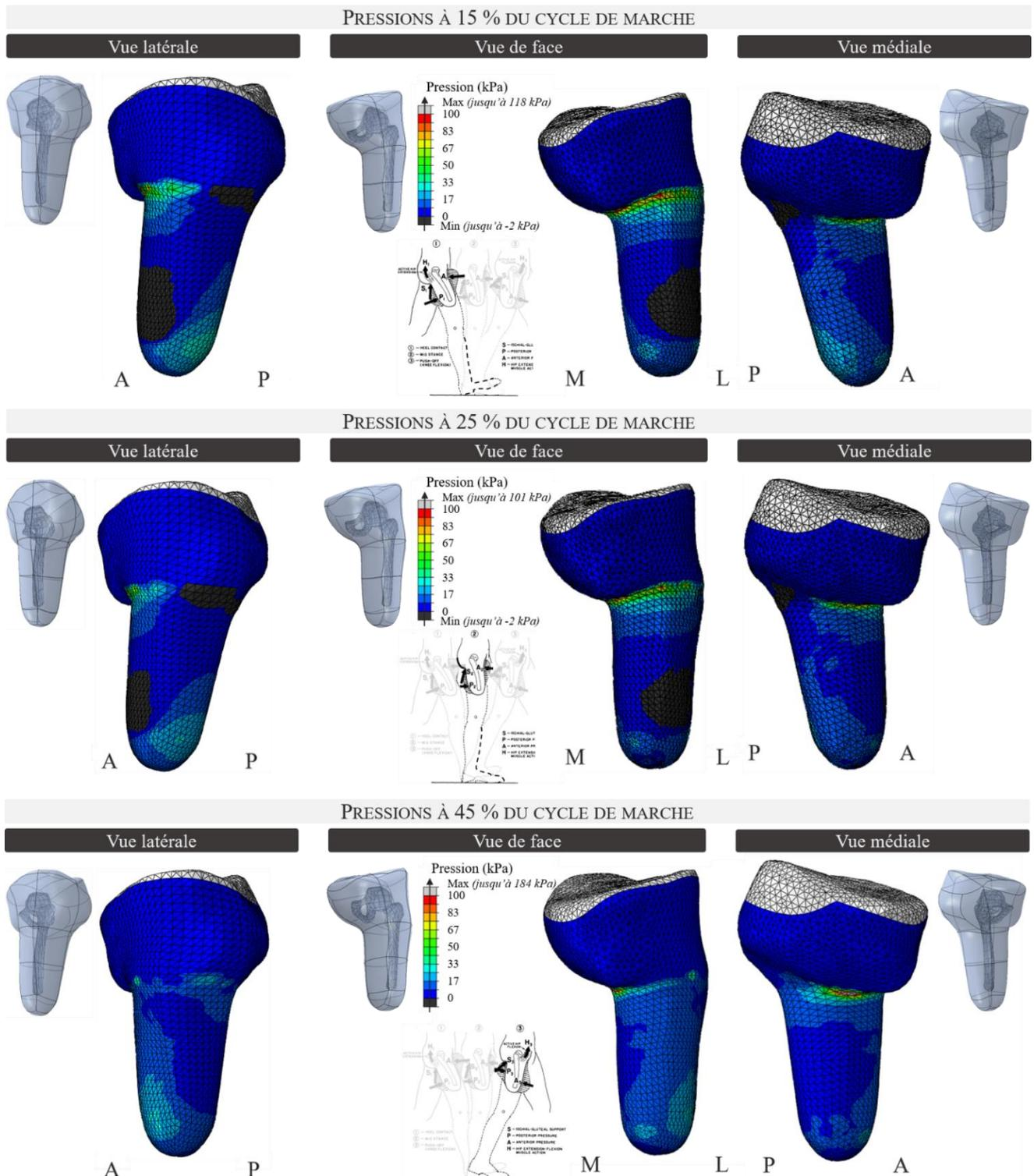
Figure 71 : Cartographie des pressions à l'interface avec l'emboîture en vue de face et vues de profil pour 15 %, 25 % et 45 % du cycle de marche. Les pressions sont indiquées en MPa. M = face médiale, L = face latérale, A = face antérieure, P = face postérieure.
