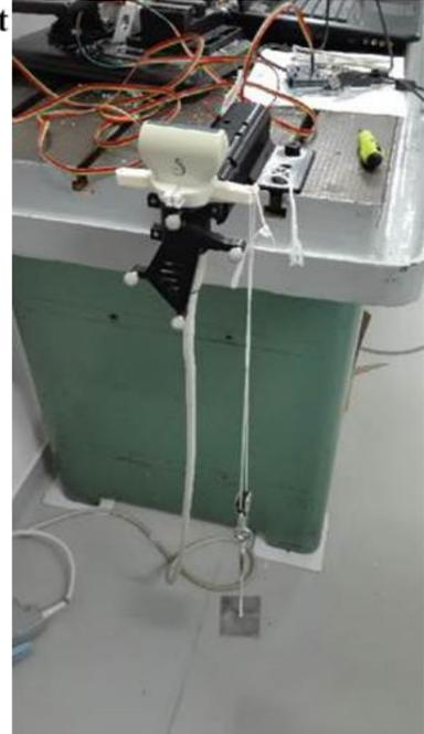
Figure 105 : Évaluation des mesures obtenues avec le capteurs d'effort de la sonde dans le cas d'un chargement asymétrique par chargement progressif de masses étalons.
