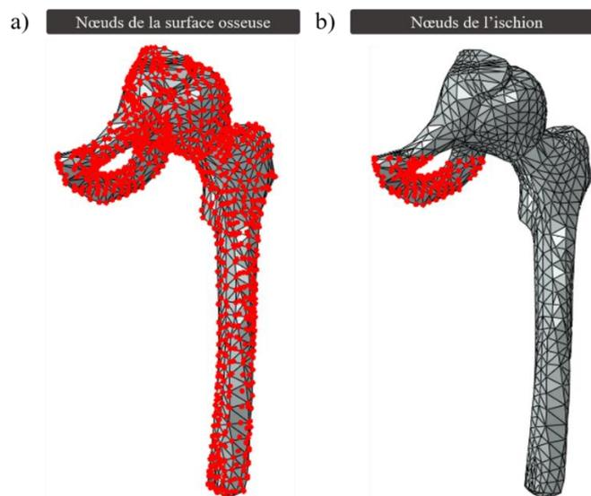
Figure 69 : Nœuds utilisés pour l'extraction des efforts de contact (a) sur l'ensemble de la structure osseuse ainsi que (b) sur la branche ischio-pubienne.
