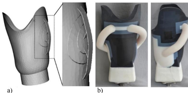
Figure 11 : Concepts d'emboîtures (a) à géométrie souple, d'après (Faustini et al., 2006a), et (b) à raideur variable, d'après (Sengeh et al., 2013)
