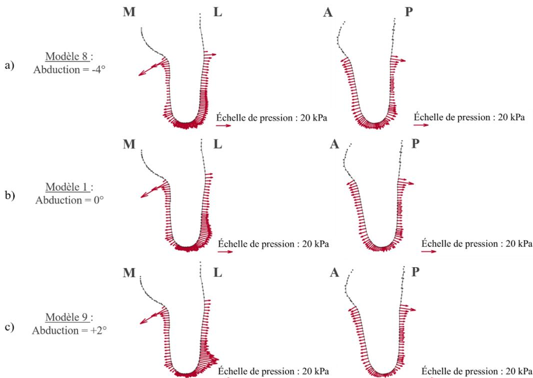
Figure 90 : Comparaison des profils antéro-postérieur et médio-latéral de pressions pour différentes valeurs d'abduction du fémur (a, b et c). M indique la face médiale du membre résiduel, L la face latérale, P la face postérieure et A la face antérieure.
