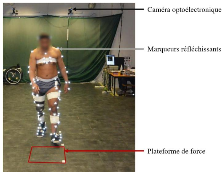
Figure 41 : Salle d'analyse quantitative du mouvement équipée d'un système de mesure optoélectronique et de plateformes de force.
