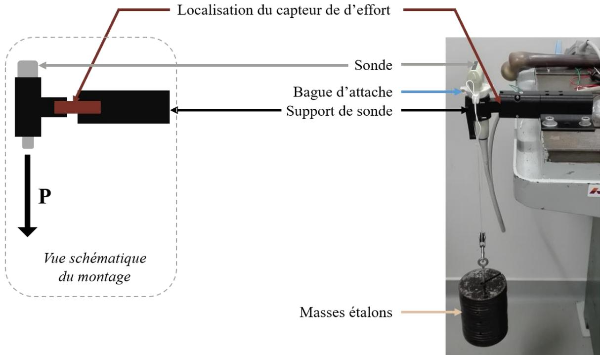
Figure 100 : Montage expérimental pour l'évaluation de la justesse des mesures d'effort du capteur localisé dans la poignée de la sonde ultrasonore.  $P$ , sur la vue schématique indique la direction du poids appliqué à l'instrumentation via les masses étalons.
