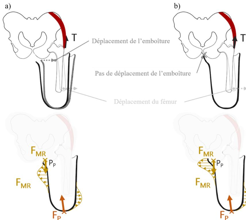
Figure 17 : Abduction du fémur avec (a) une emboîture quadrilatérale et (b) une emboîture à ischion intégré. Dans le cas (a), l'abduction du fémur engendre un déplacement latéral de l'emboîture qui vient compresser les tissus mous sur le flan médial du membre résiduel. Dans le cas (b), le bord médial de l'emboîture, prenant appui sur la branche ischiatique, empêche ce déplacement.
