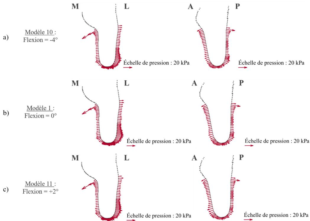
Figure 92 : Comparaison des profils antéro-postérieur et médio-latéral de pressions pour différentes de flexion du fémur (a, b et c). M indique la face médiale du membre résiduel, L la face latérale, P la face postérieure et A la face antérieure.
