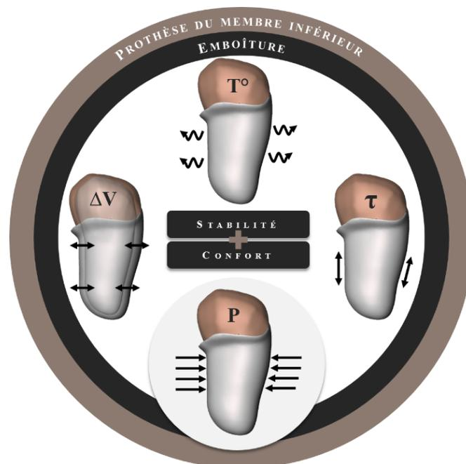
Figure 22 : Description des paramètres impactant la qualité de l'interface entre le membre résiduel et l'emboîture. L'étude des pressions est une première approche pour évaluer la qualité d'une emboîture. Adaptée de (Paternò et al., 2018).
