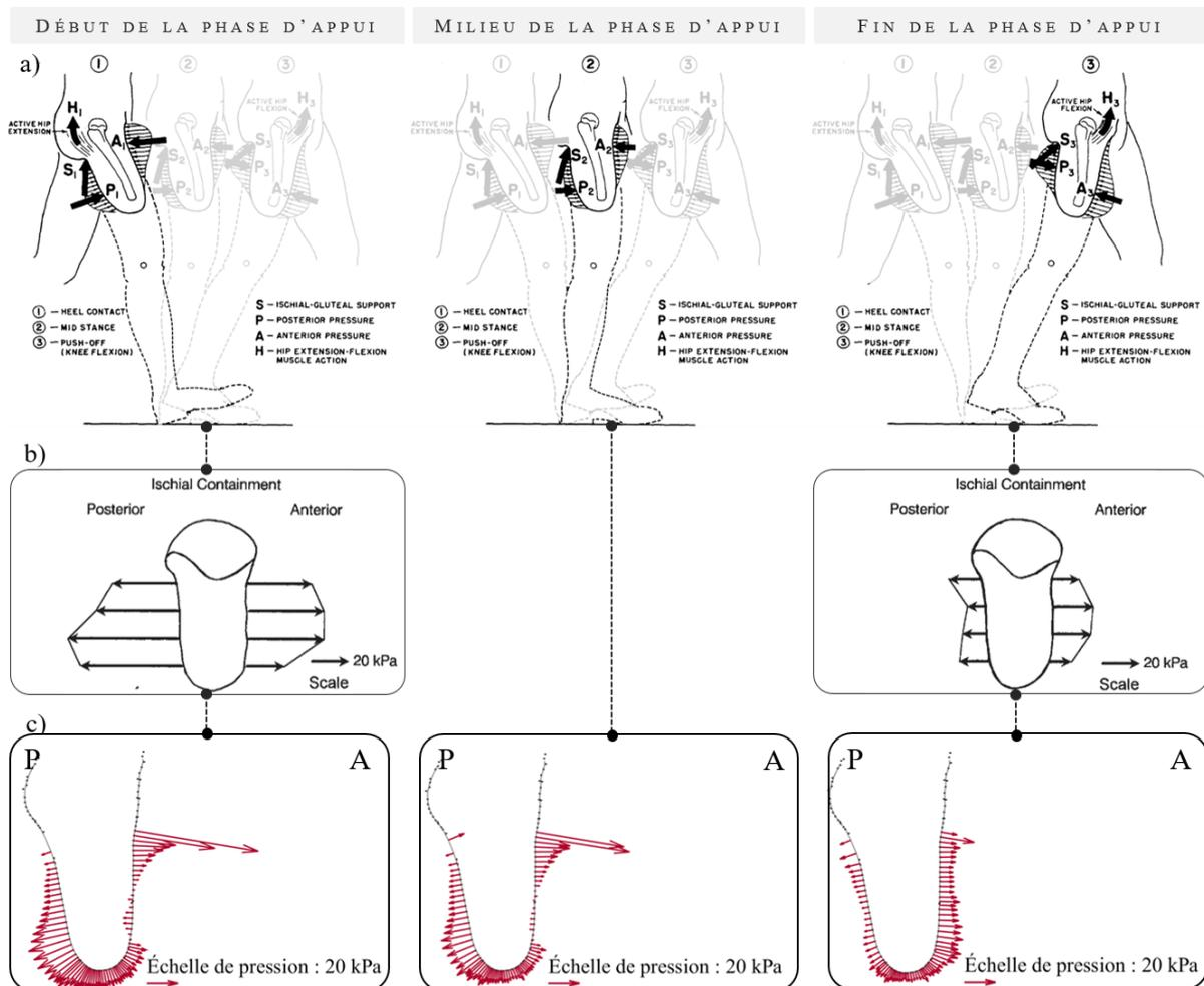
Figure 77 : Comparaison des profils de pression durant la marche appareillée dans le plan sagittal tels que décrits par Radcliffe (a), avec les mesures réalisées par Lee et al. 1997 (b) ainsi qu'avec les résultats des simulations de la présente étude (c). Les mesures présentées en (b) correspondent aux profils de pression pour
