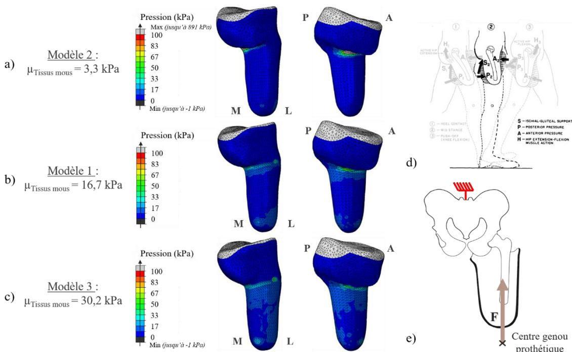
Figure 80: Comparaison des répartitions de pressions pour différentes valeurs de module de cisaillement des tissus mous (a, b et c). Le chargement imposé correspondait à l'effort vertical (e) calculé pour 25 % du cycle de marche (d). M indique la face médiale du membre résiduel, L la face latérale, P la face postérieure et A la face antérieure.
