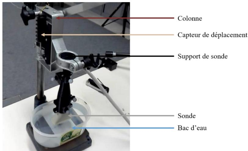
Figure 99 : Montage d'évaluation des mesures de déplacement réalisées avec la sonde ultrasonore.
