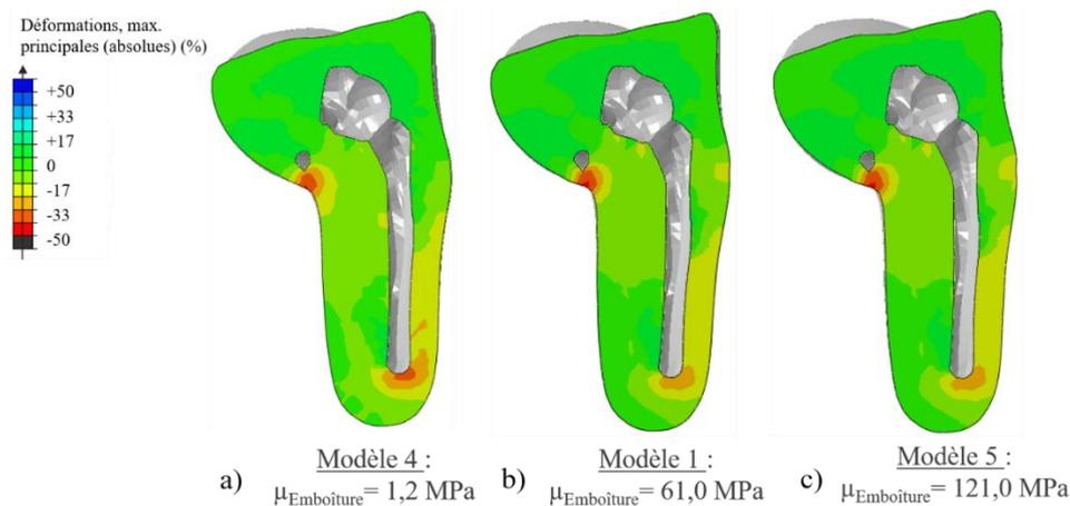
Figure 88 : Déformations logarithmiques maximales principales estimées des tissus mous pour les différents modèles de comportement mécanique de l'emboîture.
