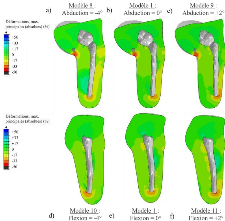
Figure 93 : Déformation logarithmiques principales maximales des tissus mous dans le plan frontal du membre résiduel pour les différentes valeurs d'abduction (a, b, c) et de flexion (d, e, f) du fémur.
