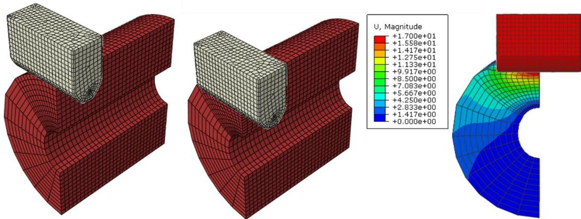
Figure 38 : (a) Modèle avant déformation pour l'identification des propriétés matériaux des tissus mous de la cuisse. (b) Modèles après application d'un déplacement de 17 mm sur la sonde. (c) Déplacement des tissus mous induit par l'indentation.
