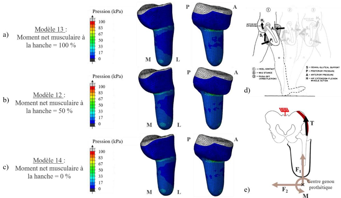
Figure 94 : Comparaison des répartitions de pressions pour différentes valeurs de moment repris par l'appui (a, b et c). Le chargement imposé correspondait à l'effort vertical, l'effort horizontal ainsi que le moment d'abduction (e) calculé pour 15 % du cycle de marche (d). M indique la face médiale du membre résiduel, L la face latérale, P la face postérieure et A la face antérieure.
