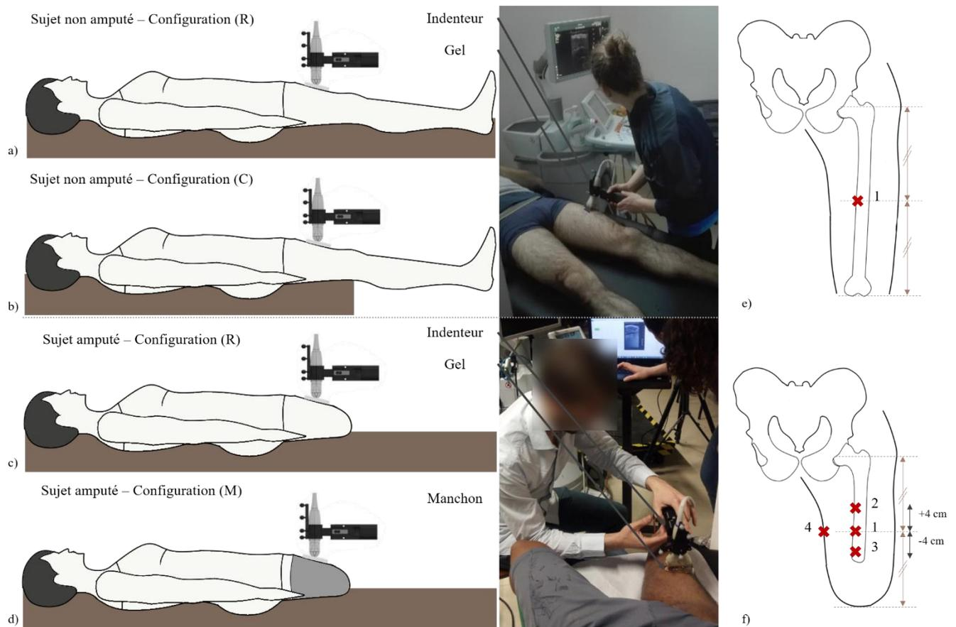
Figure 32 : Mise en place des acquisitions d'indentations pour les sujets non amputés dans la configuration de référence (R) (a) et dans la configuration contractée (C) (b) ainsi que pour le sujet amputé dans la configuration de référence (R) (c) et dans la configuration avec manchon (M) (d). Les croix rouges numérotées de 1 à 4 correspondent aux différents sites d'indentation (e et f).
