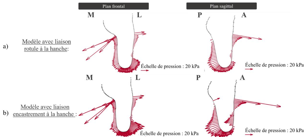
Figure 75 : Comparaison des profils de pression dans les plans frontal et sagittal pour un modèle représentant la hanche comme une liaison rotule (a) et un modèle représentant la hanche par une liaison encastrement (b). M = face médiale, L = face latérale, A = face antérieure, P = face postérieure.
