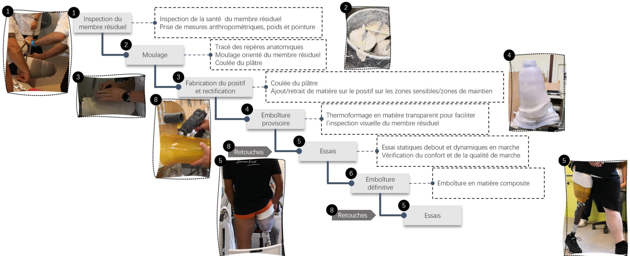
Figure 8 : Processus traditionnel de fabrication de l'emboîture. Les images sont extraites de la formation NU-FlexSIS délivrée à Proteor en novembre 2019
