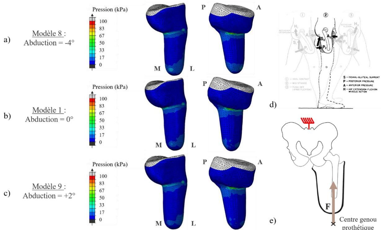
Figure 89 : Comparaison des répartitions de pressions pour différentes valeurs d'abduction du fémur (a, b et c). Le chargement imposé correspondait à l'effort vertical (e) calculé pour 25 % du cycle de marche (d). M indique la face médiale du membre résiduel, L la face latérale, P la face postérieure et A la face antérieure.
