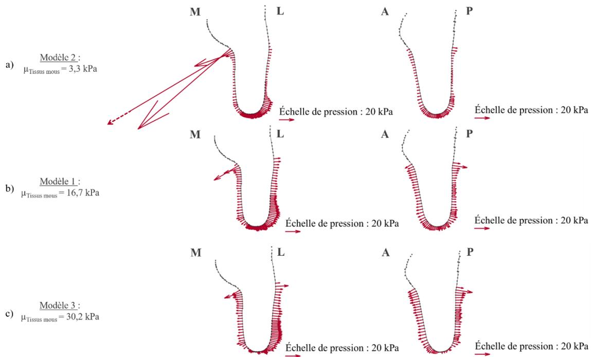
Figure 81 : Comparaison des profils antéro-postérieur et médio-latéral de pressions pour différentes valeurs de module de cisaillement des tissus mous (a, b et c). M indique la face médiale du membre résiduel, L la face latérale, P la face postérieure et A la face antérieure.
