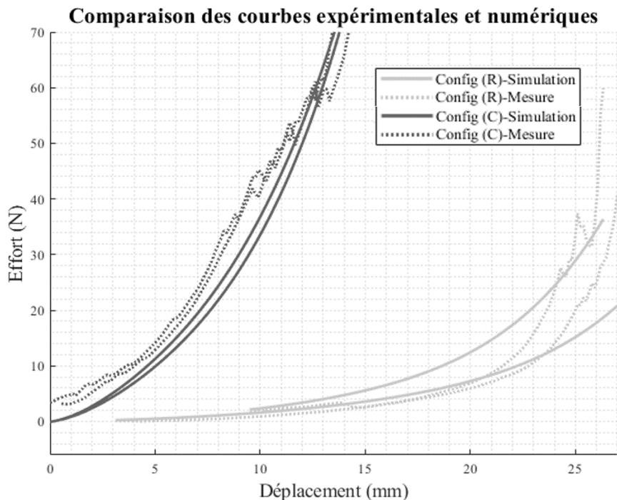
Figure 39 : Comparaison des courbes expérimentales (pointillés) et des courbes simulées (traits pleins) pour la configuration (R) (gris clair) et la configuration (C) (gris foncé) pour les deux opérateurs dans le cas d'un des sujets non amputés.
