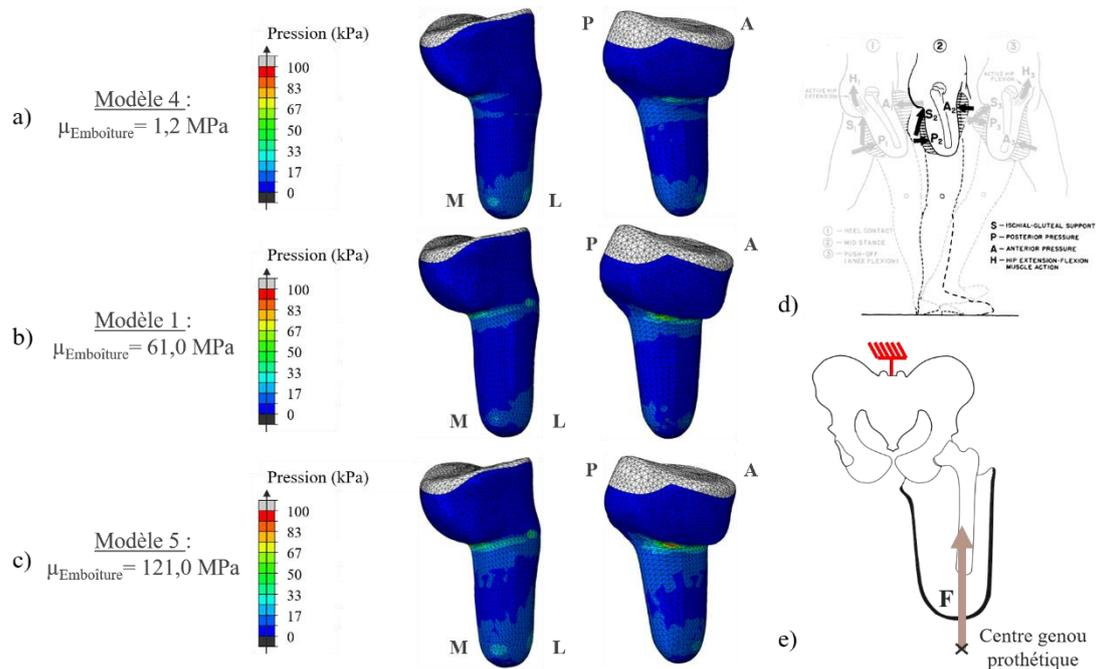
Figure 86 : Comparaison des répartitions de pressions pour différentes valeurs de module de cisaillement du bord proximal de l'emboîture (a, b et c). Le chargement imposé correspondait à l'effort vertical (e) calculé pour 25 % du cycle de marche (d). M indique la face médiale du membre résiduel, L la face latérale, P la face postérieure et A la face antérieure.
