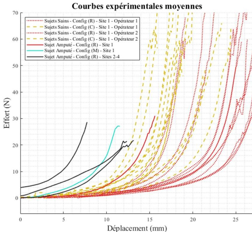
Figure 37 : Courbes expérimentales d'effort/déplacement obtenues pour l'ensemble des sujets non amputés (pointillés) ainsi que pour le sujet amputé (traits pleins).
