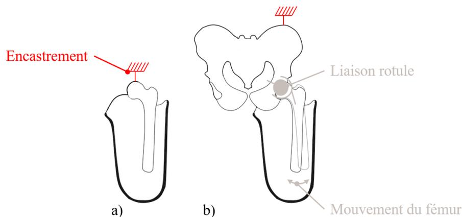
Figure 28 : Exemple de modélisation où (a) le fémur est encasté et où (b) la liaison coxo-fémorale modélisée par une rotule.
