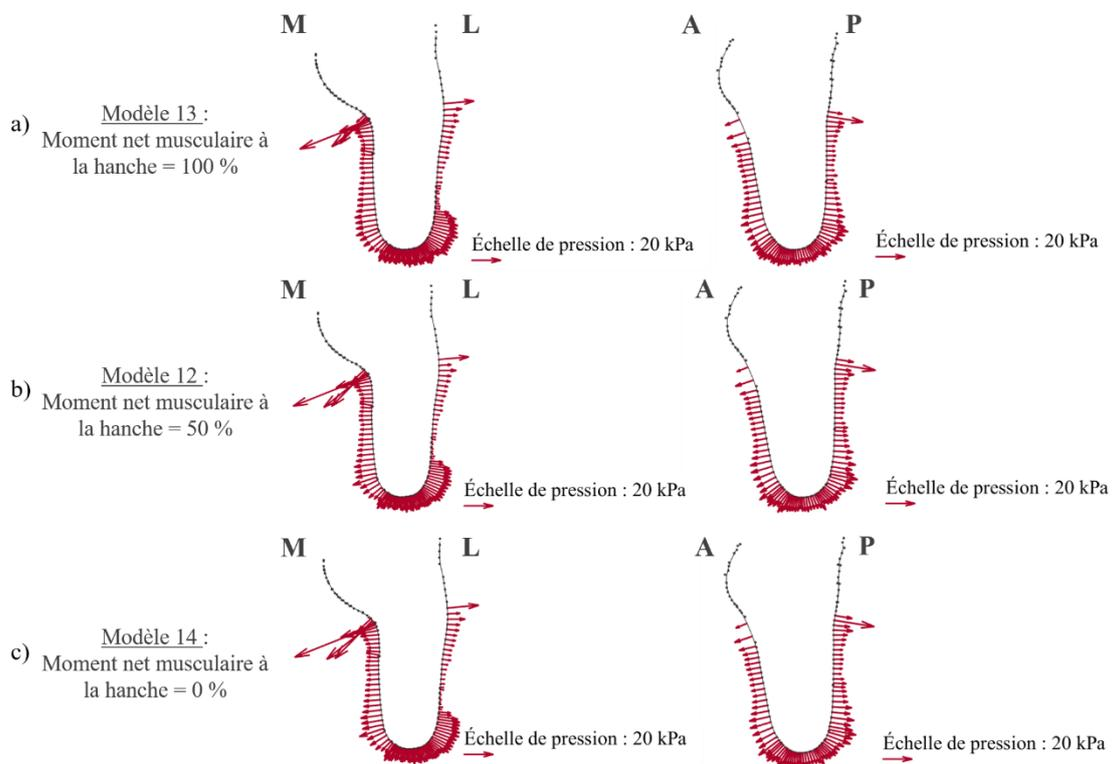
Figure 95 : Comparaison des profils antéro-postérieur et médio-latéral de pressions pour différentes valeurs de moment repris par l'appui (a, b et c). M indique la face médiale du membre résiduel, L la face latérale, P la face postérieure et A la face antérieure.
