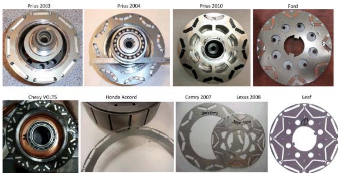
Figure 1.13 : Topologies de rotors à aimants pour machines de traction dans le marché de l'automobile [11].
