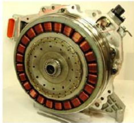
Figure 1.15 : Bobinage dentaire du moteur de la Hyundai Sonata 2011 [11].
