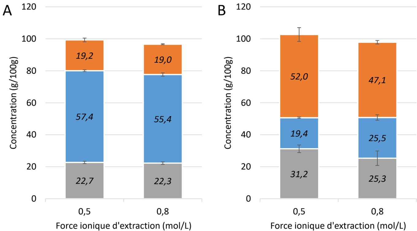
Figure IV.3 : Répartition en masse humide (A) et en masse sèche (B) des différentes fractions\* du mix d'arachide préparé à une force ionique de 0,5 ou 0,8 mol/L. En orange : surnageant ; en bleu : fraction intermédiaire ; en gris : culot. \*fractionnement par centrifugation à 10 000 g pendant 2 h. Les écarts-types sont obtenus par l'analyse de la composition de trois mix différents.
