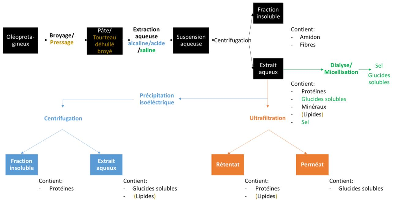
Figure I.15 : Procédé d'extraction en phase aqueuse des protéines d'oléoprotéagineux. D'après Boye et al., 2010; Chéreau et al., 2016; Morel et al., 2016
