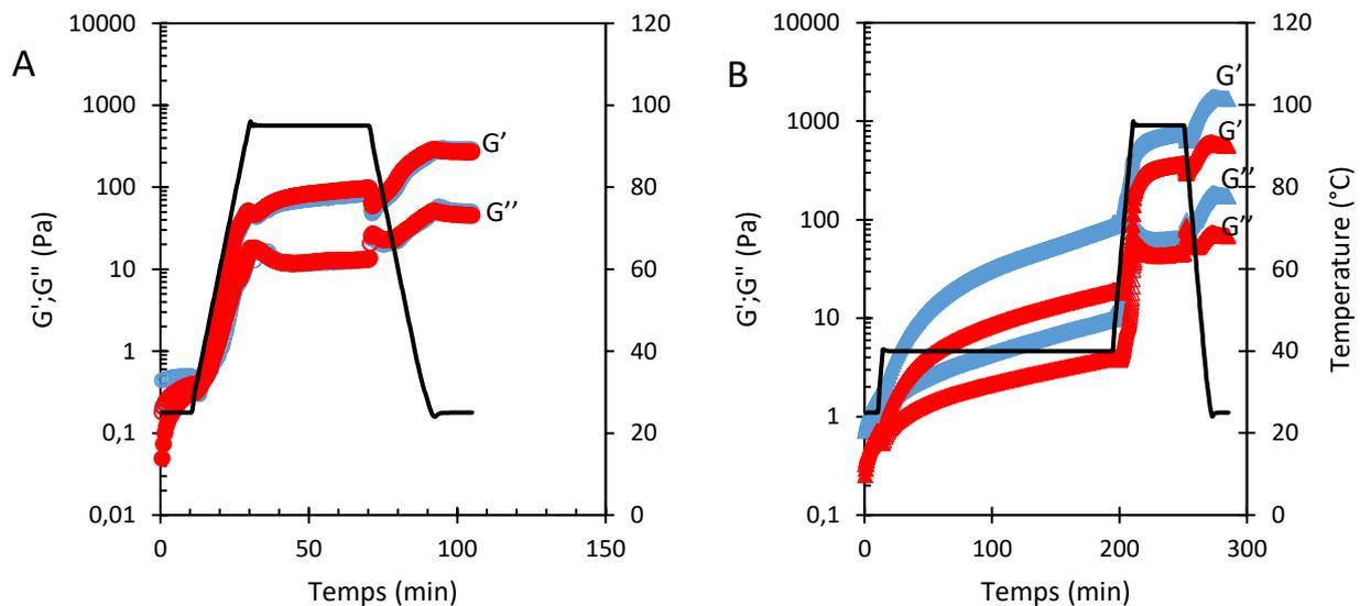
Figure IV.13. : Evolution des modules de conservation  $G'$  et de perte  $G''$  de suspensions d'arachide au cours de différents procédés de gélification. (A) Traitement thermique seul et (B) prétraitement enzymatique suivi d'un traitement thermique. Les suspensions à 0,5 mol/L de force ioniques sont représentées en bleu et celles à 0,8 mol/L en rouge.
