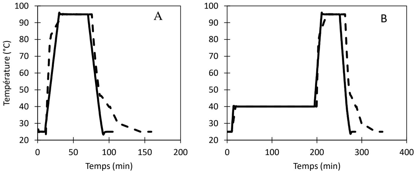
*Figure S2 : Comparaison des traitements thermiques appliqués lors d'une gélification dans le rhéomètre (trait plein) ou au bain-marie (trait pointillé). Cas d'une gélification sans prétraitement enzymatique (A) et avec un prétraitement enzymatique (B)*
