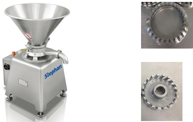
Figure III.1 : Photos du broyeur MC15 utilisé (à gauche), ainsi que de la couronne (en haut à droite) et la tête de coupe (en bas à droite)
