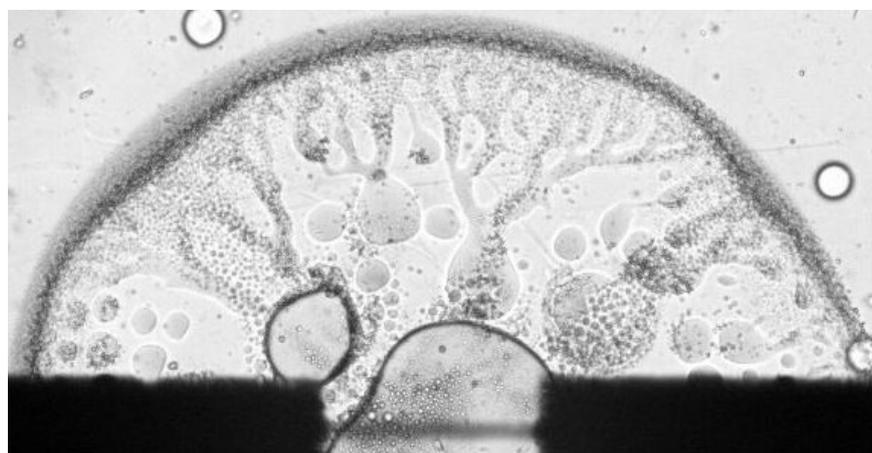
FIGURE 2.58 – Séparation d'un mélange *eau* – *LI* avec condition de mouillage partiel. Le film de *LI* présent sur le fond de la cavité forme des ramifications rejoignant le centre. Les gouttelettes entraînées vers le centre suivent ces ramifications. Les lignes triples sont sujettes à des événements de "pinning-depinning".  $\Phi_{LI} = 25 \text{ wt}\%$ .  $V = 7 \text{ Volt}$ .  $H = 60 \mu\text{m}$ .
