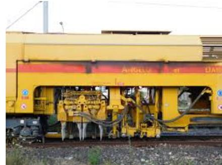
FIGURE 1.10 – Bourreuse mécanique
