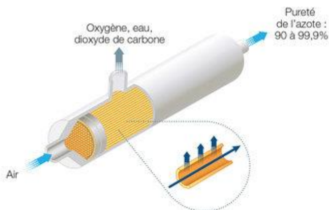
Figure 4. Schéma d'un module de production d'azote par procédé membranaire [2].
