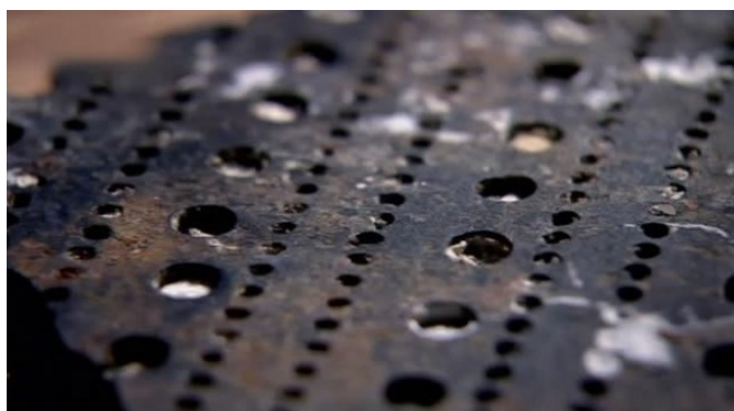
FIGURE 1.3: Tuiles d'Alberich retrouvées sur le U-480 allemand.
