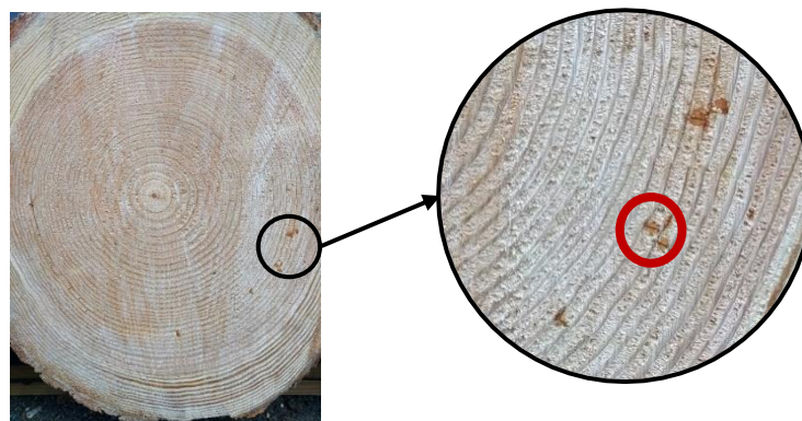
Figure 26 : Billon de douglas avec fissures radiales
