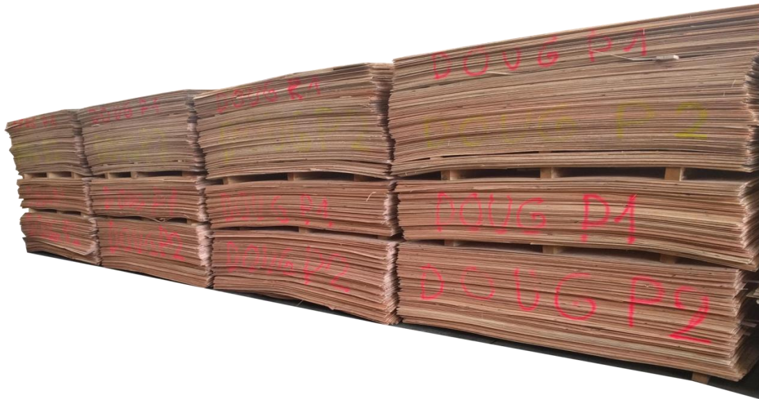
Figure 92 : Piles de placages triés selon leur position dans la bille et leur provenance
