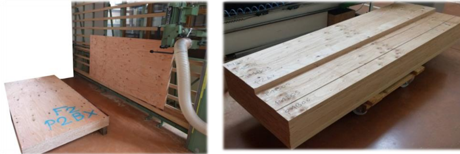
Figure 95 : Scie à panneau (à gauche) et poutres délignées (à droite)
