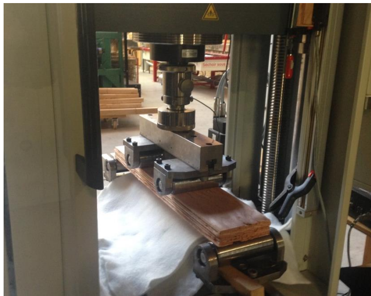
Figure 76 : Montage d'essais de flexion 4 points selon la norme NF EN 408
