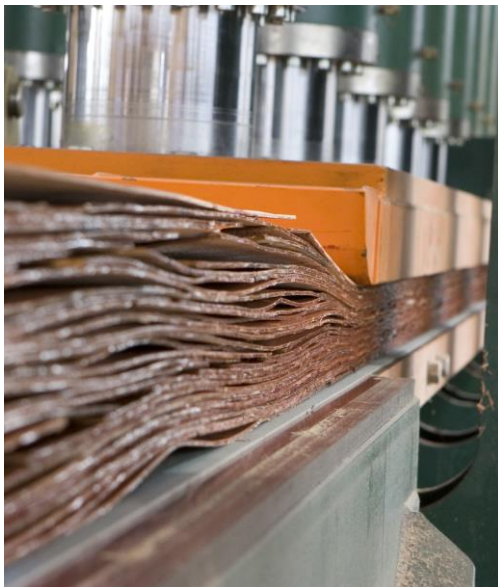
Figure 12 : Pressage à chaud de panneaux de LVL [11]
