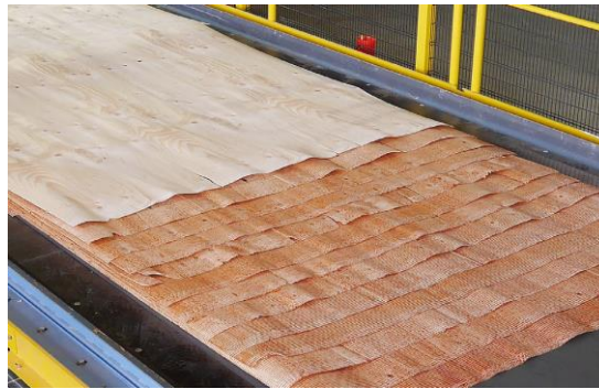
Figure 11 : Assemblage et décalage des placages [11]
