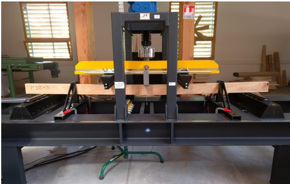
Figure 97 : Poutre de LVL sur banc de flexion 4 points du LaBoMaP
