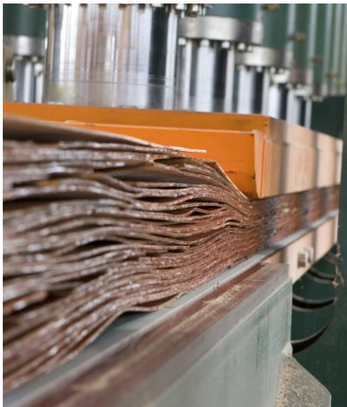
Figure 12 : Pressage à chaud de panneaux de LVL [11]
