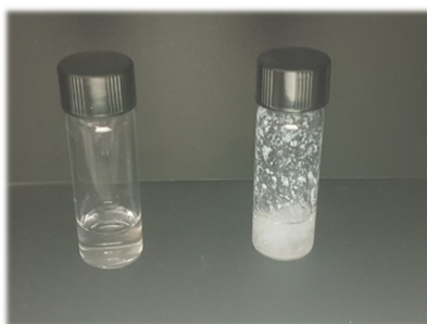
Figure VI 1 Solution de pNIPAM dans de l'eau MilliQ à 20°C (à gauche) et dans une solution de NaCl à 2 mol.L -1 (à droite).
