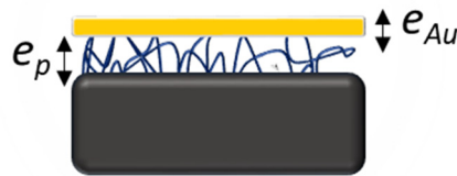
Figure III 2 Représentation schématique d'une bicouche pNIPAM / Or.
