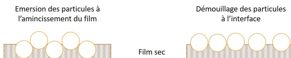
FIGURE 2.13 – Schéma des hypothèses sur l'apparition de la rugosité
