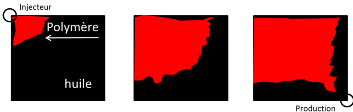
Figure 7 : Polymer flooding : Ratio de mobilité M < 1 .
