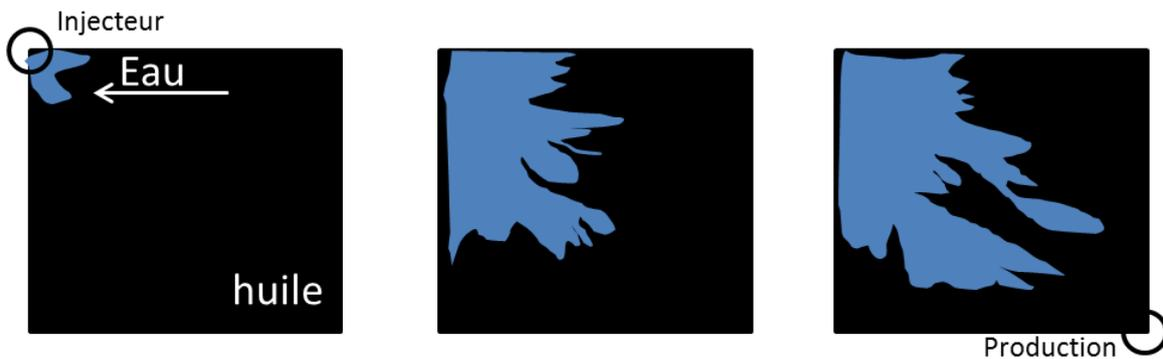
Figure 6 : Water flooding : Ratio de mobilité  $M > 1$  Viscous fingering.
