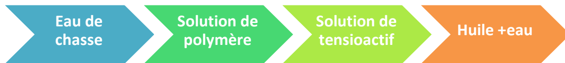
Figure 21: Représentation des différentes étapes successives d'injection d'un procédé surfactant-polymère
