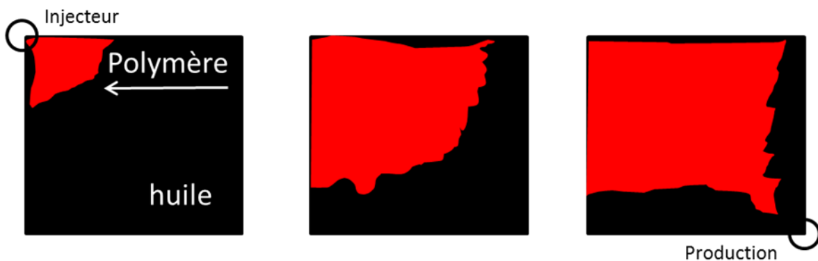
Figure 7 : Polymer flooding : Ratio de mobilité M < 1 .
