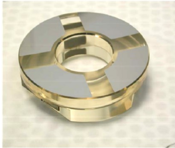
Figure 25. Miroir primaire de EUVI/STEREO traité avec un revêtement multicouche Mo/Si. Le diamètre du miroir est de 105 mm. [25]
