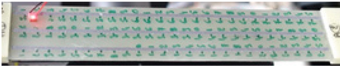
Figure 2.3 – Epreuve instrumentée à l'aide de 3 bandes de scotch light (réfléchissantes), présentant chacune 25 graduations équidistantes. Ces repères sont au nombre de 75 et constituent les nœuds de notre maillage expérimental.
