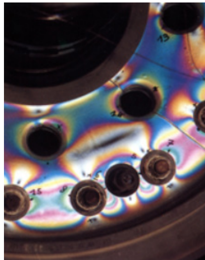
Figure 1.19 – Visualisation des zones à fort gradient de contraintes [37].
