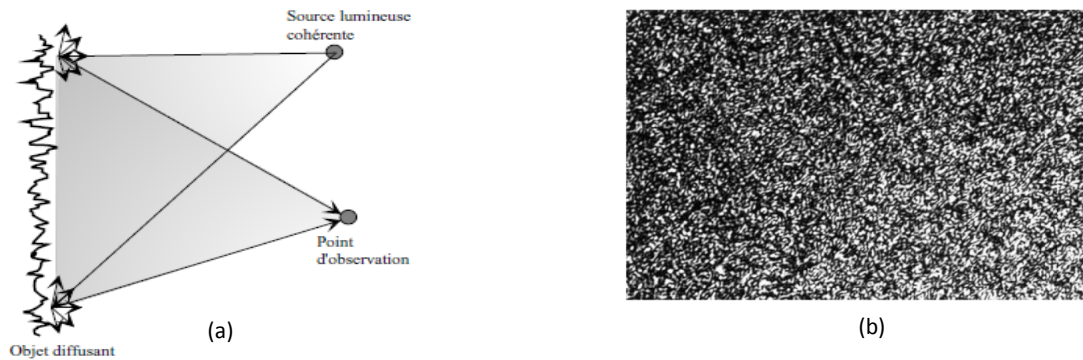
Figure 1.21 – Illustration du schéma d'observation (a) et de l'image d'une figure de Speckle (b) [43].
