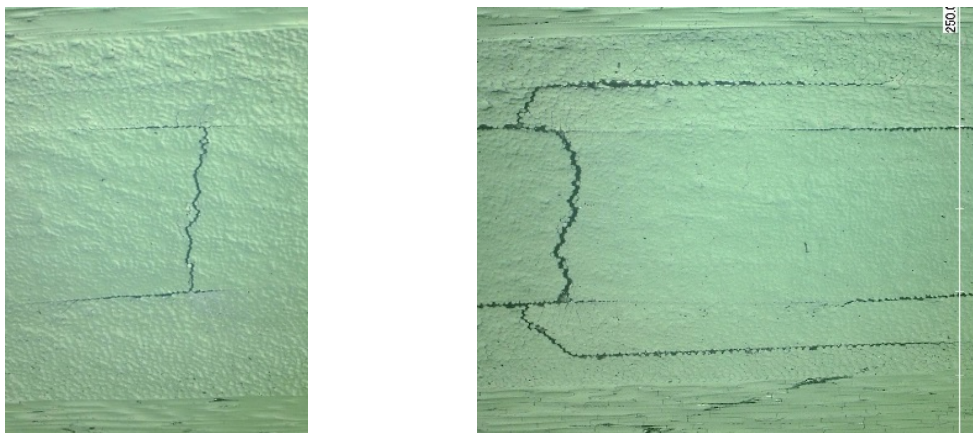
Figure 4.26 – Observation des fissures interlaminaires en bord d'éprouvette.
