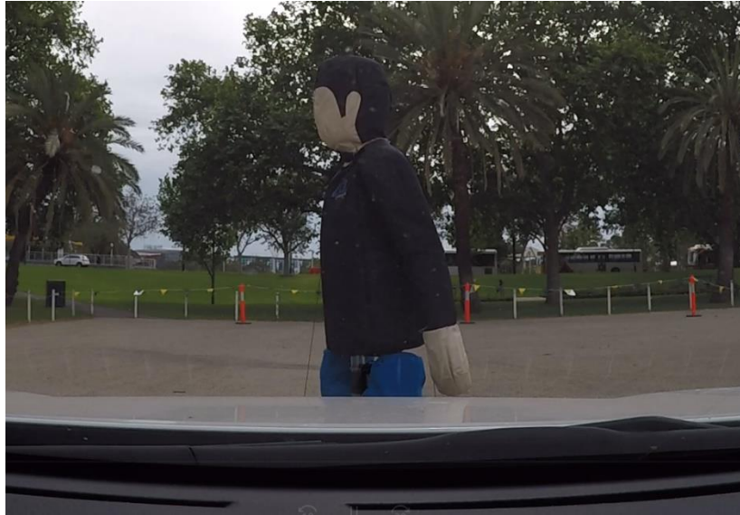
Figure 39 : Mannequin vu depuis l'intérieur du véhicule, après freinage AEB
