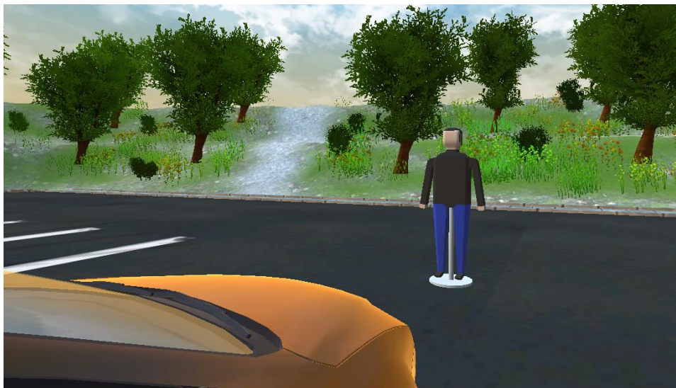
Figure 51 : Parking des essais et mannequin déclenchant le freinage AEB
