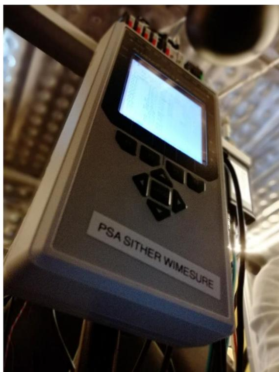
Figure 80 – Unité d'acquisition des données WiMeasure
