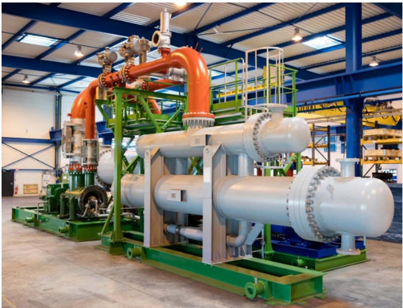
Figure 6.4: Exemple d'une installation de 3,2 MW pour la récupération de la chaleur résiduelle d'une aciéria [3]
