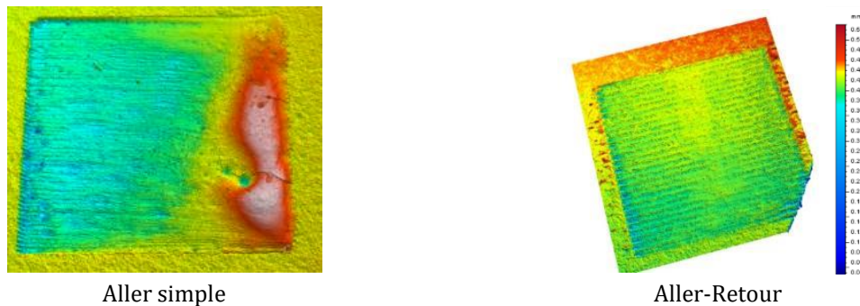
Figure VI-37 : Observation des surépaisseurs à la surface des draps 2D par profilométrie optique selon la stratégie de balayage choisie pour le système {PAZ+0,5C_SAZ} à P168V400E,0,42
