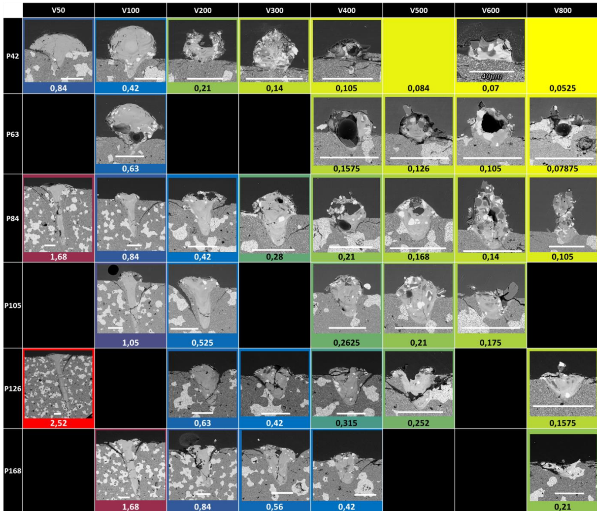
Figure VI-13 : Section transverse des monocordons pour {PAZ_SAZ} (échelle 100 \mu\text{m} sauf exception – légende : énergie linéique en \text{J}\cdot\text{mm}^{-1} )
