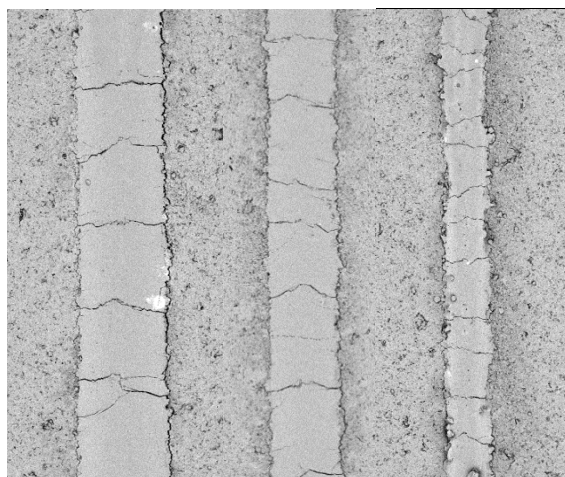
Figure II-57 : Monocordons obtenus par fusion d'un lit de poudre d'alumine mélangé au carbone (0,1% m. C) déposé sur un substrat d'alumine dense pour une vitesse de balayage croissante de gauche à droite
