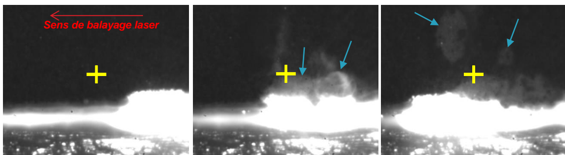
Figure VI-35 : Observation de la fabrication d'un drap par caméra rapide à P168V400 \tau ,0,7 pour le système {PAZ+0,5C_SAZ} avec la stratégie par aller simple. Les zones ponctuelles dénuées de poudre sont indiquées par les flèches bleues
