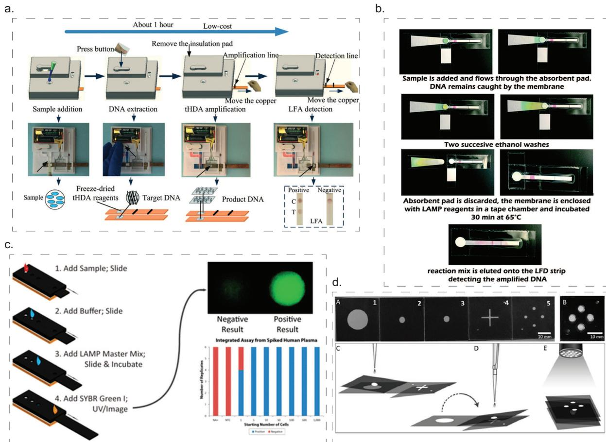
**FIGURE 1.24** – systèmes papiers sample to answer : (a) Boîtier intégré permettant la capture et l'amplification HDA, adapté de [99], Copyright RSC. (b) Système en papier + adhésif pour la capture et l'amplification LAMP sur PES, adapté de [67], Copyright RSC. (c) Paper machine, disque de FTA glissant de chambre en chambre, adapté de [89], Copyright ACS. (d) Origami pour la capture et la détection multiplexée, adapté de [88], Copyright Wiley
