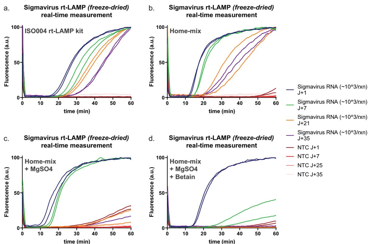
**FIGURE 4.12** – Comparaisons des durées de vie des différents mélanges réactionnels lyophilisés (a) kit ISO004-RT (b) lyophilisation maison (c) lyophilisation maison + MgSO<sub>4</sub> (d) lyophilisation maison + MgSO<sub>4</sub> + bétaine
