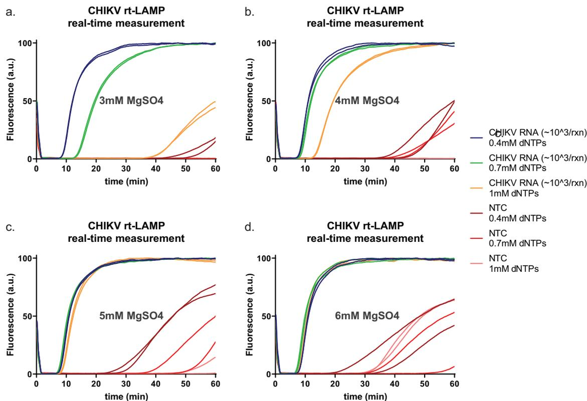
**FIGURE 2.13** – rt-LAMP Chikungunya, Suivi de la réaction en temps réel par SYTO82. variations des concentrations en dNTPs et MgSO<sub>4</sub> (a) 3 mM de MgSO<sub>4</sub>, 0,4-0,7-1 mM de chaque dNTPs (b) 4 mM de MgSO<sub>4</sub>, 0,4-0,7-1 mM de chaque dNTPs (c) 5 mM de MgSO<sub>4</sub>, 0,4-0,7-1 mM de chaque dNTPs (d) 6 mM de MgSO<sub>4</sub>, 0,4-0,7-1 mM de chaque dNTPs
