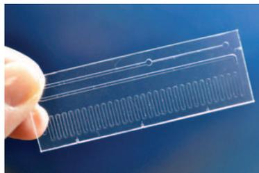
**FIGURE 1** – Puce microfluidique permettant de réaliser une PCR pour la détection du virus de la grippe. Adapté de [4]
