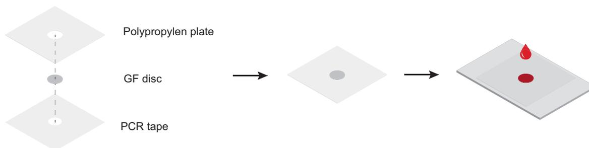
**FIGURE 4.3** – Schéma résumant la fabrication du système papier de capture d'acide nucléique
