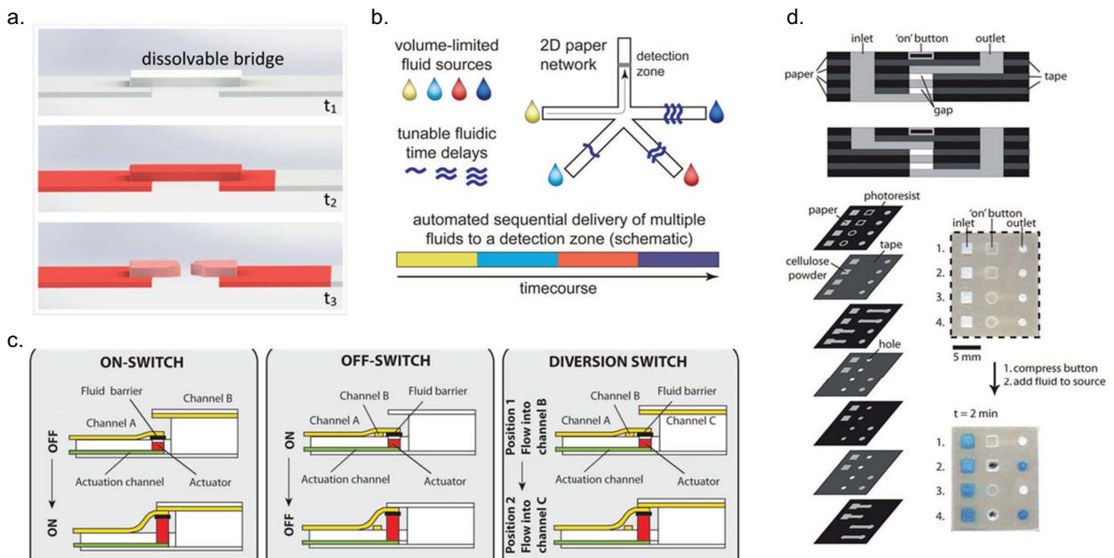
**FIGURE 1.17** – Fonctions de valves sur papier : (a) Stop-flow par la dissolution d'un pont, adapté de [70], *Copyright ACS*. (b) Contrôle de l'arrivée séquentiels des fluides, adapté de [71], *Copyright RSC*. (c) Valves mécaniques par gonflement, adapté de [72] *Copyright RSC*. (d) Valves basées sur la déformation du papier par une pointe de stylo, adapté de [73] *Copyright RSC*.
