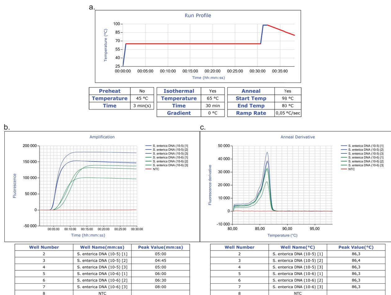
**FIGURE 2.1** – LAMP en tube et mesures types sur l'appareil Genie III. (a) Description du protocole de chauffe réalisé par le Genie III pour une (rt-)LAMP en tube. (b) LAMP *S. enterica*, ADN de *S. enterica*, dilutions successives. Suivi de la réaction en temps réel par agent intercalant, et tableau des valeurs pic de dérivées premières. (c) Dérivée première de la courbe de fusion.
