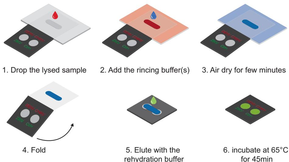
**FIGURE 4.6** – Schéma résumant les étapes de préparation d'échantillon pour un système à deux disques
