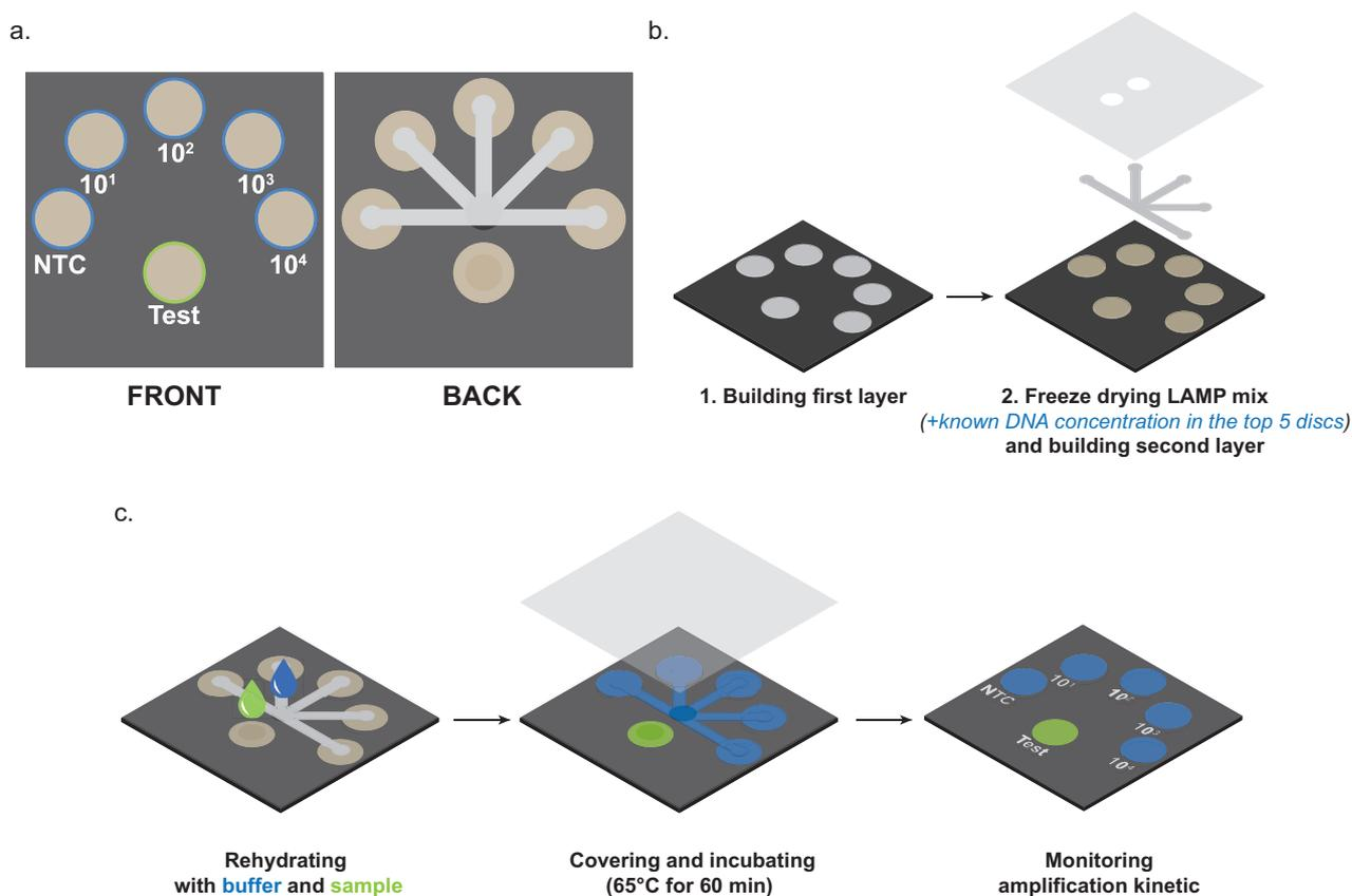
**FIGURE 2.17** – Schéma d'un dispositif de terrain de qLAMP sur papier. (a) Vues de face et de dos du dispositif (b) Protocole de fabrication (c) Principe d'utilisation.
