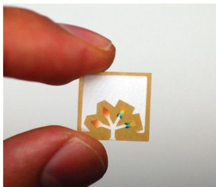
**FIGURE 1.12** – Photographie d'un système microfluidique papier pour l'analyse de la BSA et du glucose urinaire, Adapté de [6] *Copyright ACS*.
