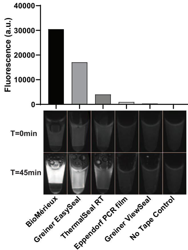
FIGURE 2.6 – LAMP *S. enterica*, contrôles négatifs réalisés dans des tubes contenant différents films adhésifs PCR.
