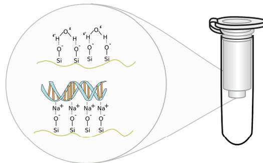
**FIGURE 1.19** – Schéma d'une colonne de silice, pour la capture des acides nucléiques.
