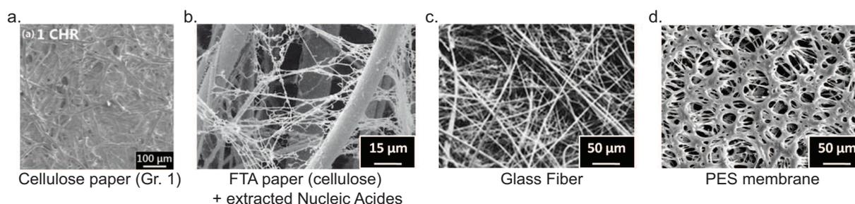
**FIGURE 1.13** – Images MEB de divers papiers : (a) Papier chromatographique, adapté de [40] (b) Papier FTA et ADN capturé (avec l'aimable autorisation de GE Healthcare) (c) Fibre de verre (avec l'aimable autorisation de Sterlitech Corp.) (d) Membrane de PES (avec l'aimable autorisation de Sterlitech Corp.)
