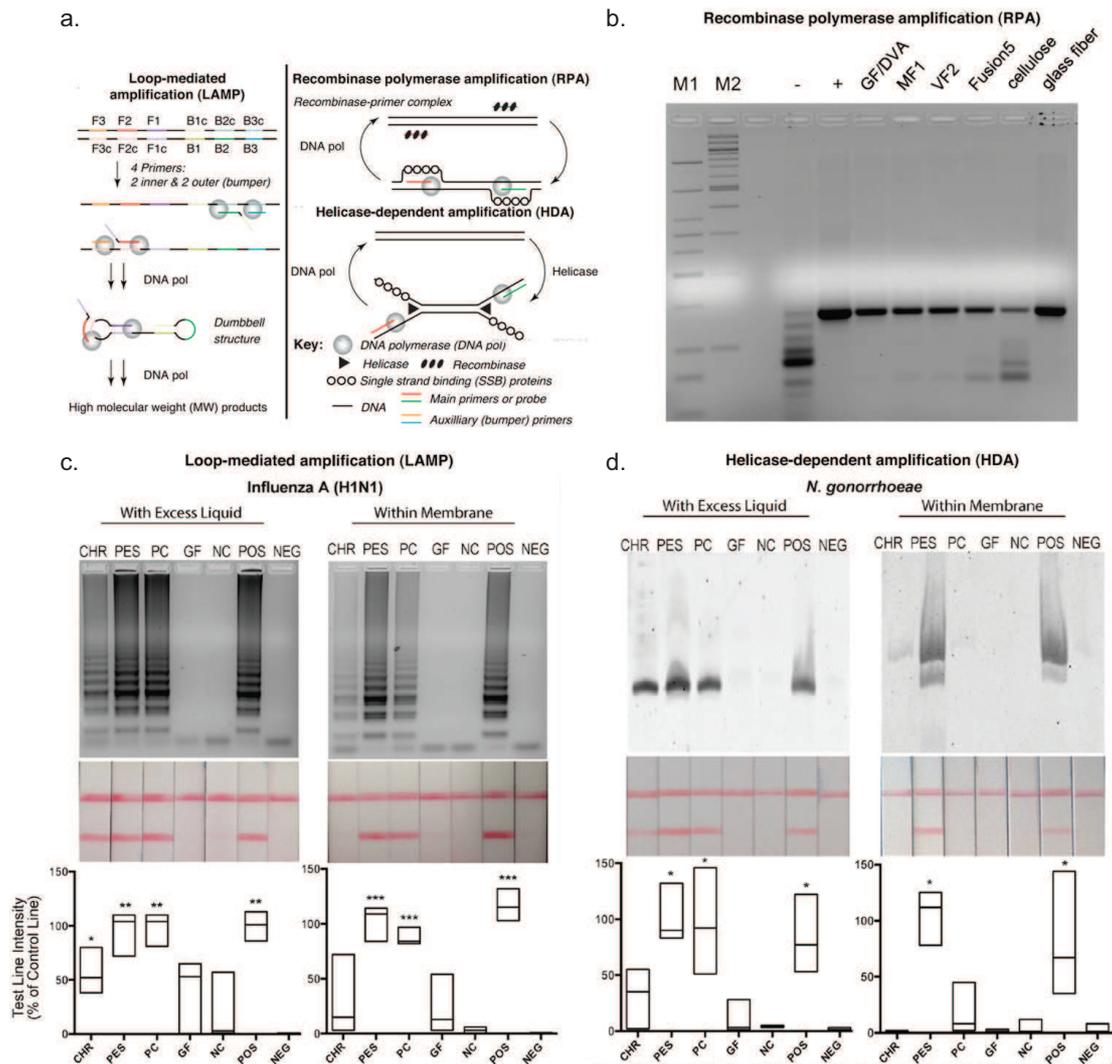
**FIGURE 1.21** – Amplifications isothermes sur papiers non traités : (a) rappel des principes de RPA, HDA et LAMP, adapté de [5], *Copyright Elsevier*. (b) Comparaison de différents supports papiers pour la RPA, adapté de [84], *Copyright RSC*. (c)(d) Comparaisons de différents supports papiers pour la LAMP et la HDA, adapté de [85], *Copyright Springer*.
