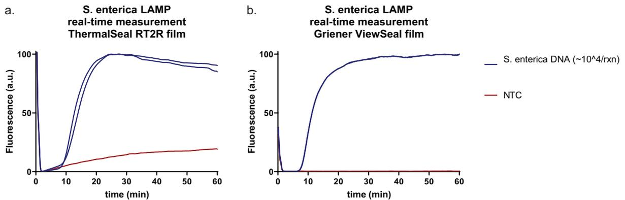
FIGURE 2.7 – LAMP *S. enterica*, Comparaison entre deux types de film pour couvrir la puce : ThermalSeal RT2R et Greiner ViewSeal.
