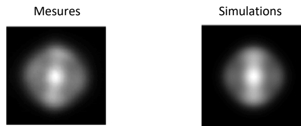
FIGURE 3.19 – Profil du faisceau à la sortie de la fibre, et simulations visant à modéliser de faisceau
