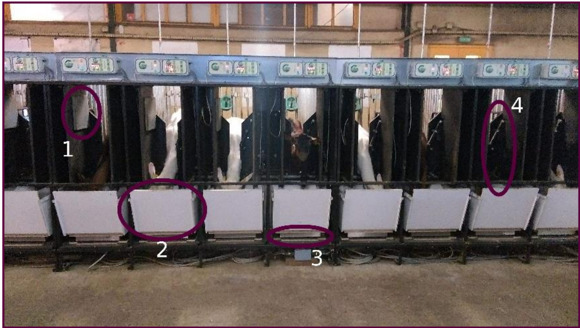
Figure 18. Photographie présentant les différentes parties des stations d'alimentation : 1) l'antenne réceptrice permettant de lire la boucle de la chèvre et la reconnaissance RFID ; 2) la mangeoire ; 3) la balance ; 4) le cornadis débloqué lors de l'identification de la chèvre (Crédit photo : Marjorie Cellier, photo personnelle).
