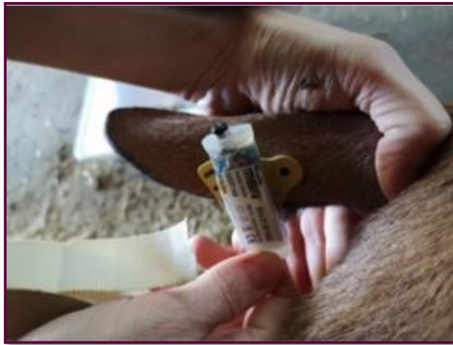
Figure 24. Photographie d'un accéléromètre positionné sur l'oreille d'une chèvre dans le but d'enregistrer la rumination (Crédit photo : Ophélie Dhumez).
