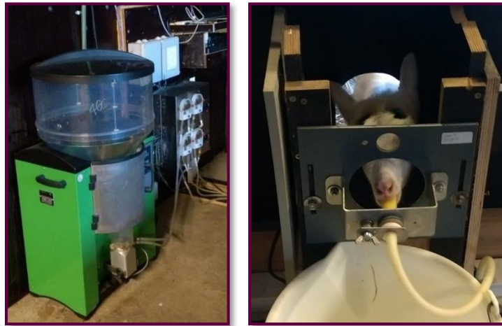
Figure 7. Photographies représentant des parties du distributeur automatique de lait A) l'unité de chauffe et de mélange de l'aliment d'allaitement, B) la tétine et le passe tête comprenant l'antenne réceptrice pour la RFID (Crédit photo : Marjorie Cellier, photos personnelles)
