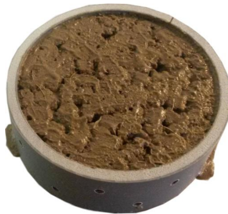
Figure 16 - Etat du demi-cosme après mise à l'équilibre des agrégats à pF1.5 puis compaction. On constate les pertes d'eau et de sol par-dessous et la mauvaise tenue des agrégats et de leur structure.
