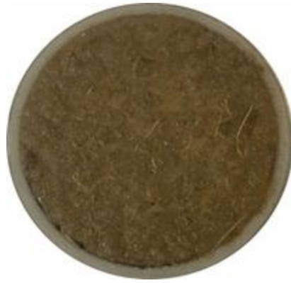
Figure 17 - Etat d'un demi-cosme après compaction puis mise à l'équilibre à pF1,5 par vaporisation. On constate la formation d'une croûte en surface et la mauvaise tenue des agrégats de surface et de leur structure.
