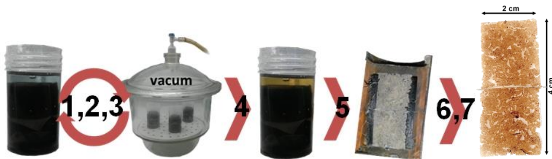
Figure 51 - Ensemble des étapes de préparation des lames minces: 1 - fixation, 2 - marquage, 3 - déshydratation, 4 - imprégnation, 5 - sciage des cosmes, 6 - amincissement et 7 – polissage.
