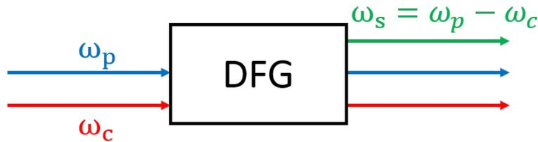
FIGURE 1.4 – Schéma de principe de la différence de fréquences qui génère la pulsation  $\omega_c$  à partir de deux ondes aux pulsations  $\omega_p$  et  $\omega_c$ .
