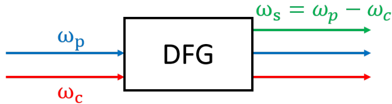
FIGURE 1.4 – Schéma de principe de la différence de fréquences qui génère la pulsation \omega_c à partir de deux ondes aux pulsations \omega_p et \omega_c .
