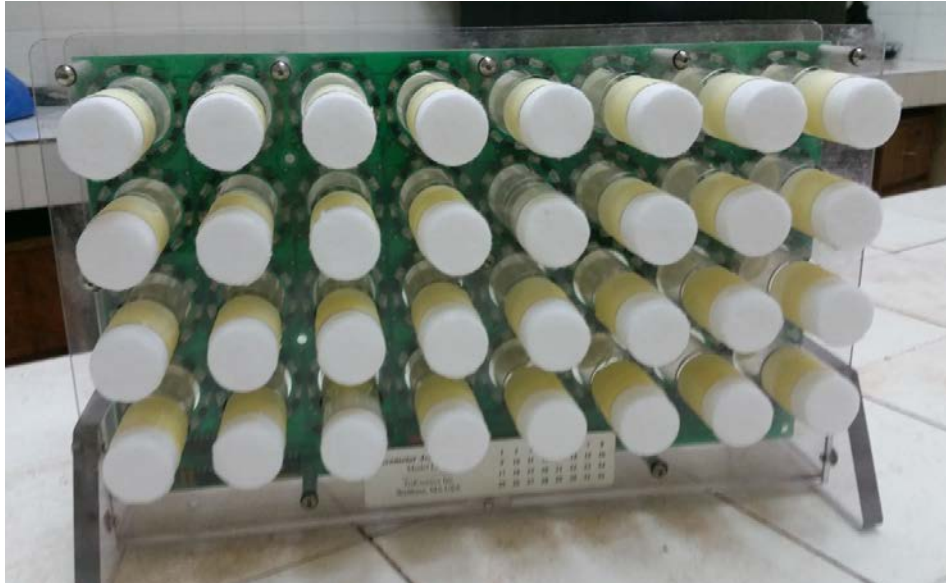
Figure 11 : Photographie d'un Moniteur d'activité locomoteur (LAM) chargé de tubes contenant les anophèles
